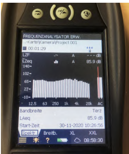
Abb. 22 Terz-Frequenzanalyse mit der Software des Messgeräts
