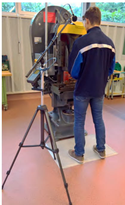
Abb. 13 und 14 Schallpegelmessgerät mit Stativ bei ortsfester Messung in Abwesenheit und in Anwesenheit eines Beschäftigten
