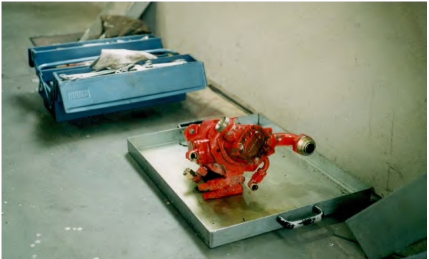
Abb. 19 Mobilhydraulikpumpe in einer Ölauffangwanne
