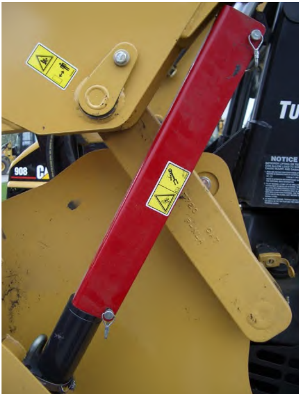
Abb. 41 Stützeinrichtung in Position an einer Erdbaumaschine
