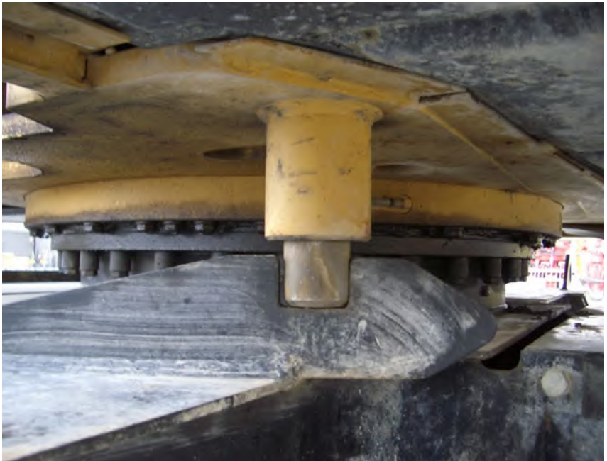
Abb. 40 Dreh Sperre an einem Hydraulikbagger in Sperrstellung
