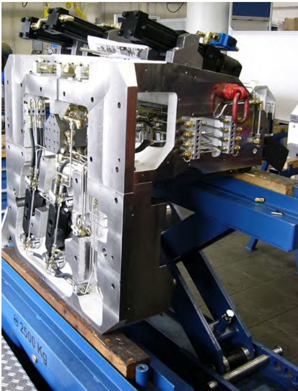
Abb. 27 Komplexes Spann- modul einer Transferstraße
