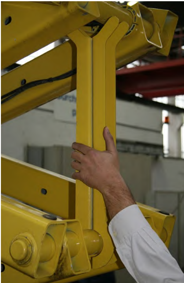
Abb. 29 Eingelegte Wartungsstütze an hydraulischer Scheren-Hubarbeits- bühne
