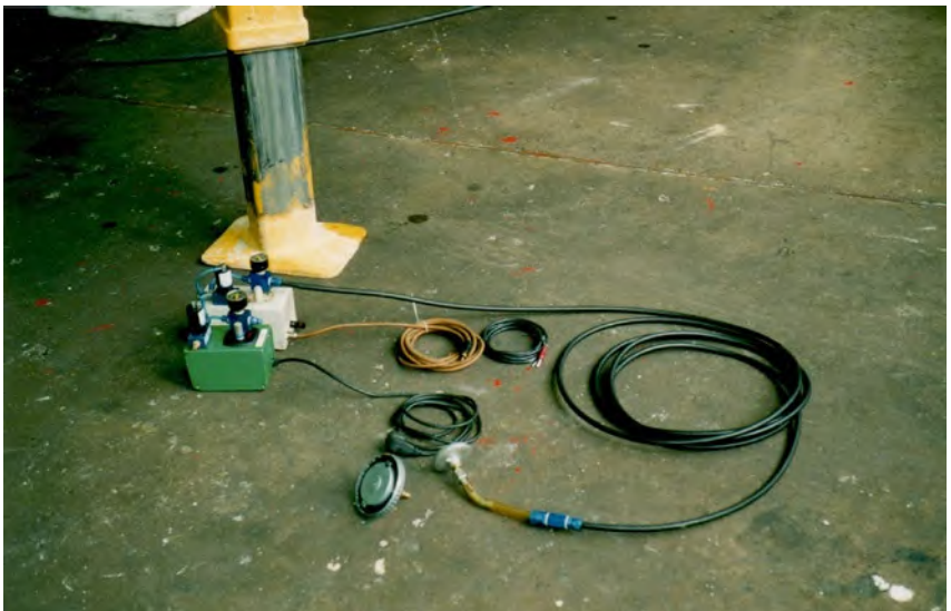
Abb. 8 Vakuumpumpen für Hydrauliktank in 24V DC- bzw. 230V AC- Ausführung
