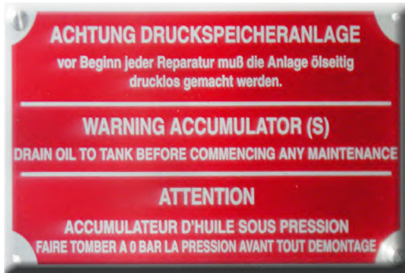
Abb. 21 Warnhinweis an Druckspeicher- anlage
