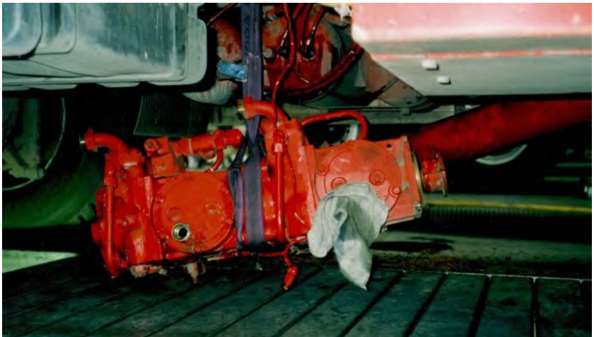
Abb. 39 Fahrzeughauptpumpe an einem Lastanschlagmittel
