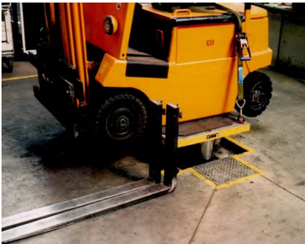
Abb. 35 Demontierte Hubgabeln bei Arbeiten an der Staplerhydraulik
