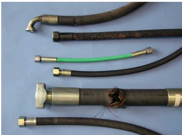
Abb. 16 Beispiele ausgefallener Hydraulik- Schlauchleitungen
