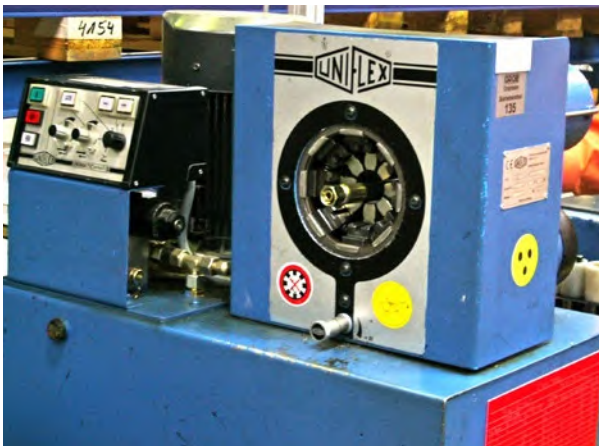
Abb. 14 Vorrichtung zum Verpressen von Schlaucharmaturen
