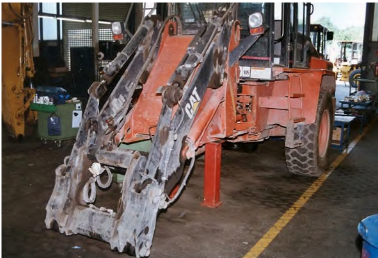
Abb. 33 Unterbaugestell bei Arbeiten am Radlader
