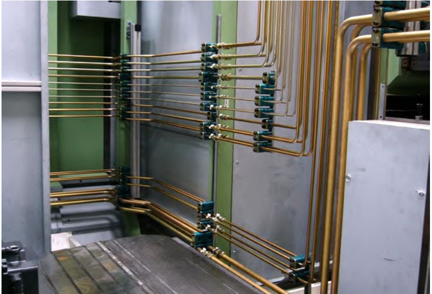
Abb. 10 Fachgerechte Befestigung von Rohrleitungen mit Leitungshalterungen
