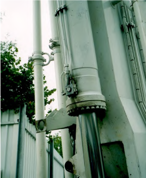
Abb. 18 Hydraulikzylinder mit entsperbarem Rückschlagventil
