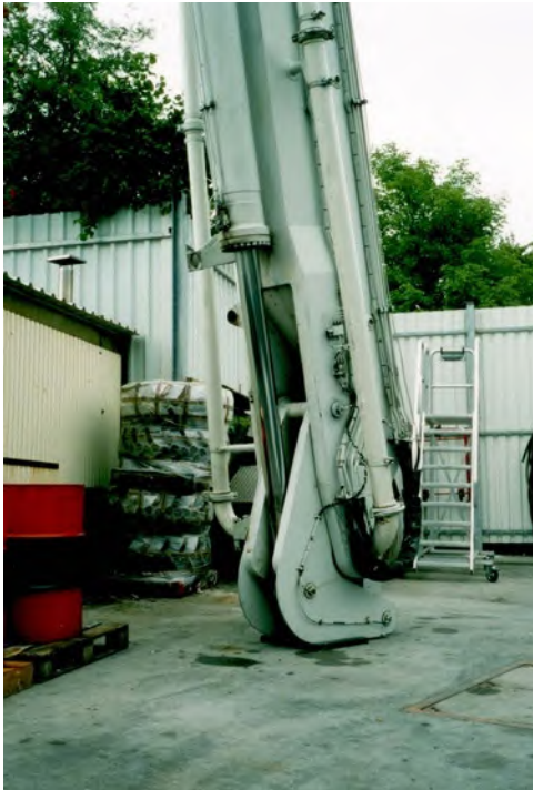
Abb. 38 Auf den Boden abgesenkter Ausleger einer Betonpumpe
