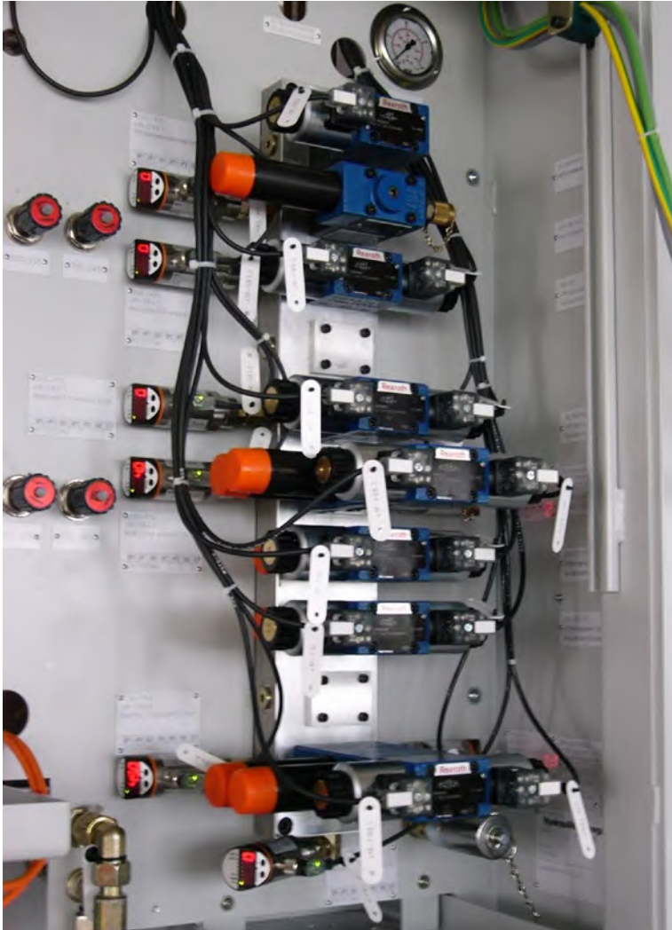
Abb. 20 Kennzeichnung von Hydraulikventilblöcken
