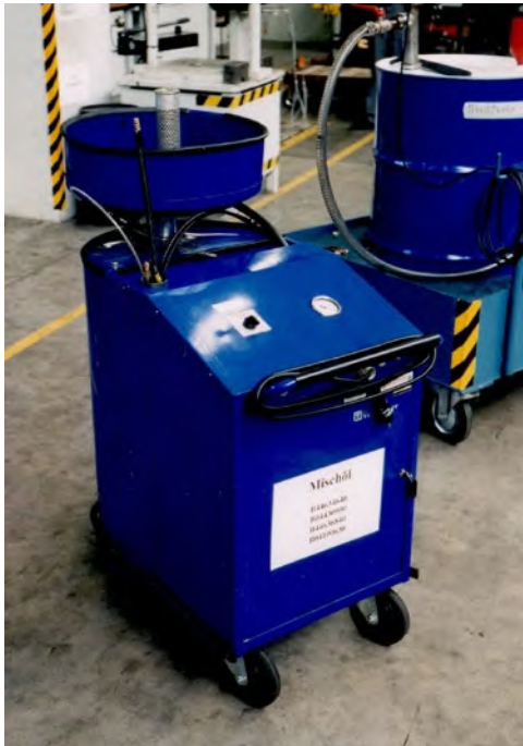
Abb. 34 Hilfsgerät zur Entsorgung von alter Druckflüssigkeit
