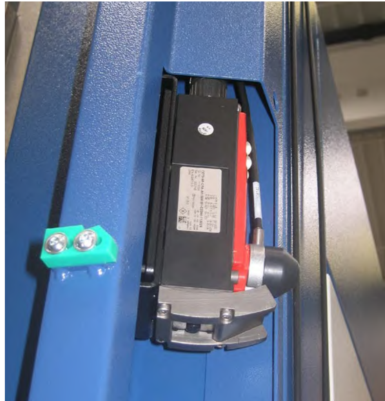
Abb. 5 Türsicherheitsschalter/Positionsschalter mit Notentriegelung mittels Bowdenzug
