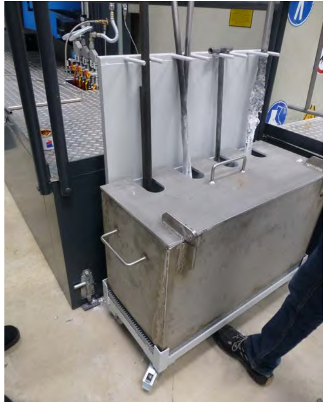
Abb. 19 Behälter für Werkzeuge zum Abkrätzen, geschlossen
