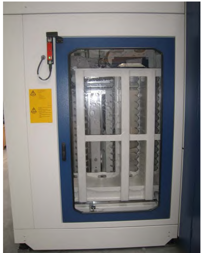
Abb. 12 Türsicherheitsschalter/Positionsschalter mit Notenspernung an Schutztür Magazinwartung
