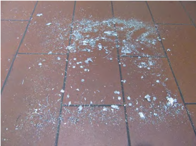
Abb. 2 Rückstände bei der Trockenbearbeitung (Magnesiumstäube und -späne)
