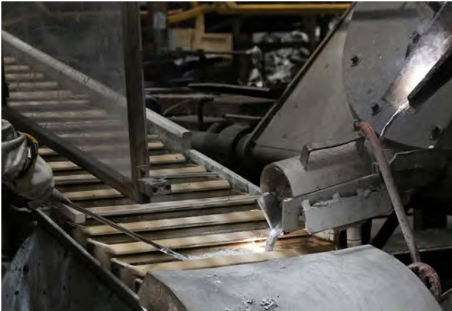
Abb. 15 Abmasseln/Herstellung von Masseln
