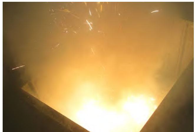
Abb. 4 Brennendes Magnesium im Spänebehälter
