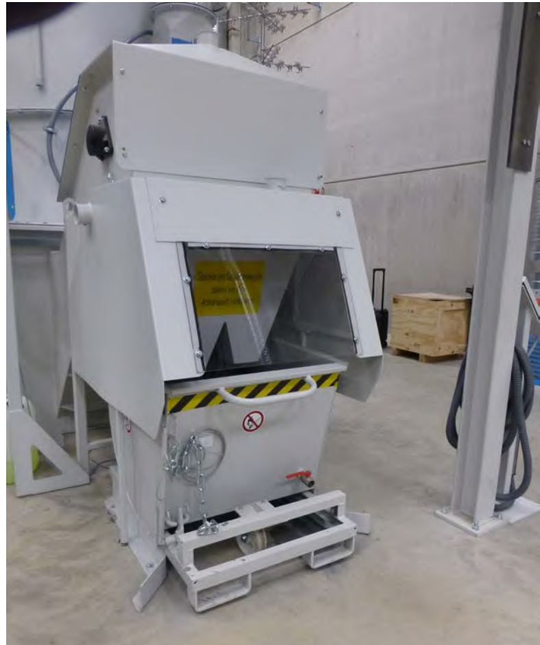
Abb. 27 Schlammwagen für Magnesiumrückstände aus Nassabscheider
