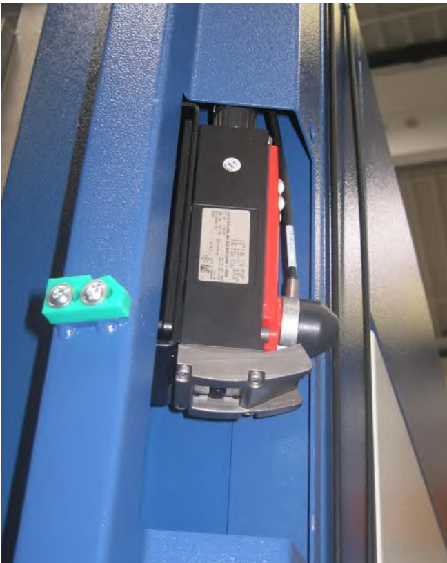
Abb. 6 Türsicherheitsschalter/Positionsschalter mit Notentsperrung mittels Bowdenzug
