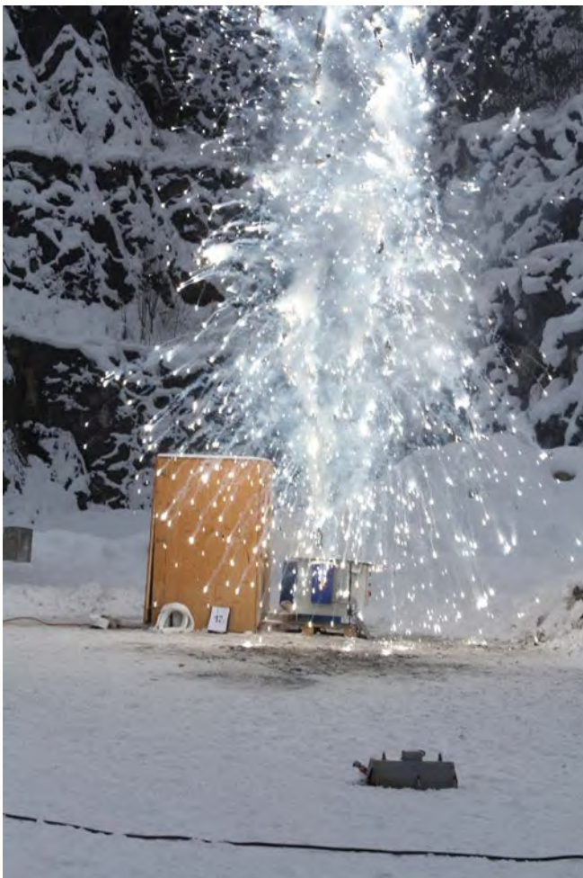
Abb. 14 Schmelzeauswurf bei eingebrachtem Wasser, ca 50 ml
