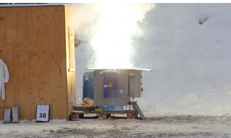
Abb. 32 Schmelzeauswurf bei Lithium-Ionen-Akku (Smartphone, Taschenlampe)
