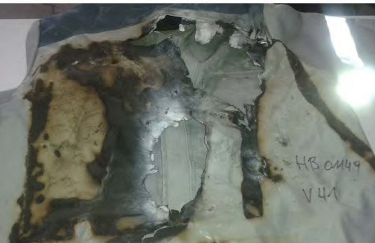
Abb. 29 Verbrannte ungeeignete Schutzkleidung
