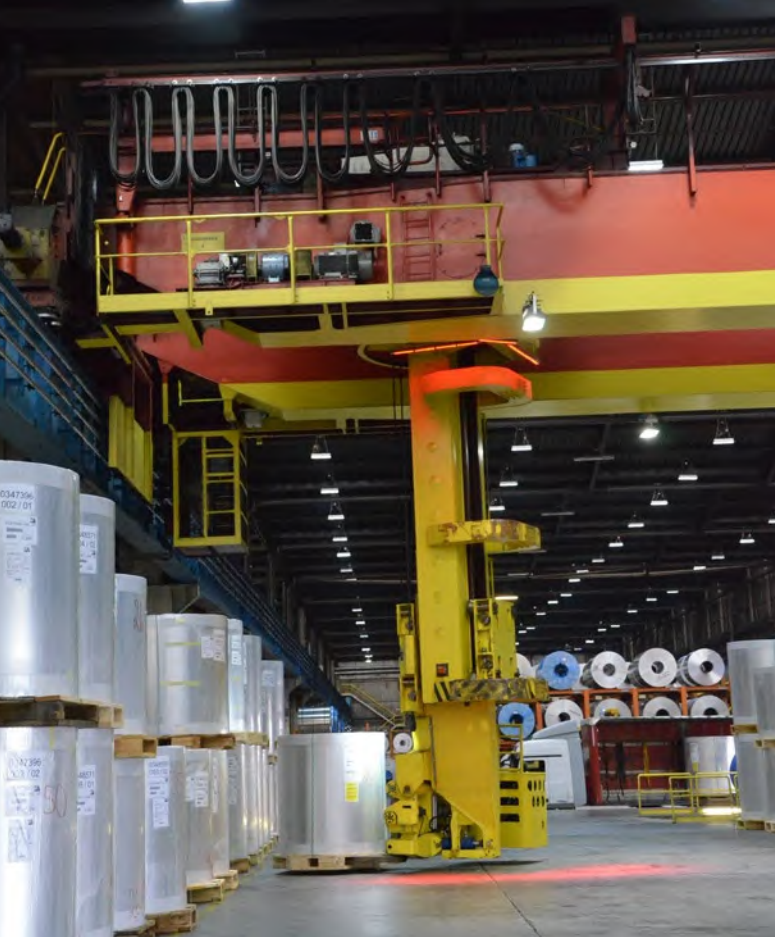
Abb. 10 Regalbedienkran mit starrer Lastführung, nicht teleskopierbar
