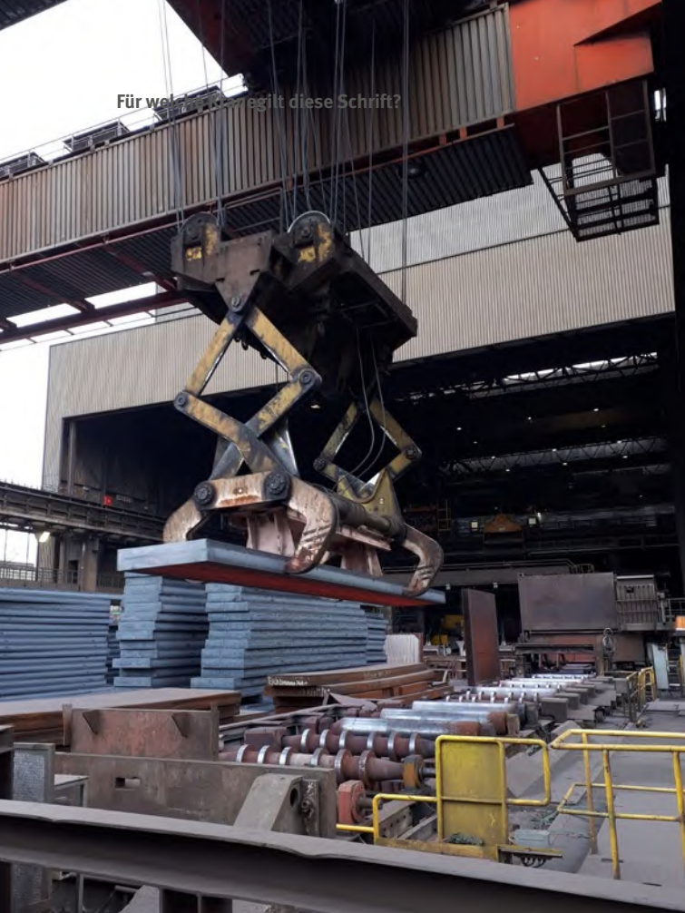
Abb. 5 Brammentransportkran mit Zange
