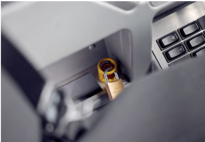
Abb. 4 Beispiel für das Sichern gegen Wiedereinschalten
