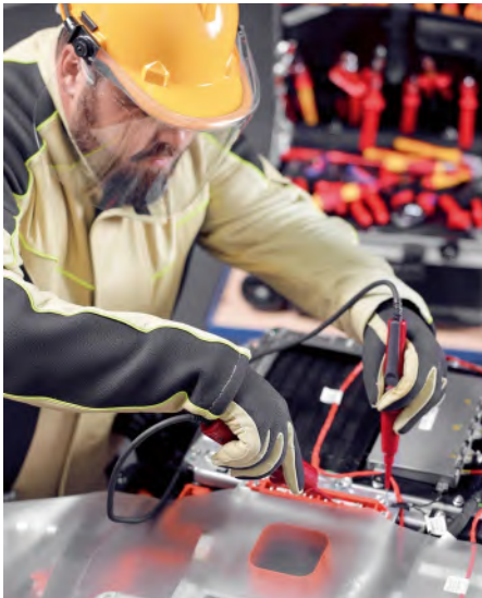
Abb. 10 Arbeiten an unter Spannung stehenden HV-Komponenten
