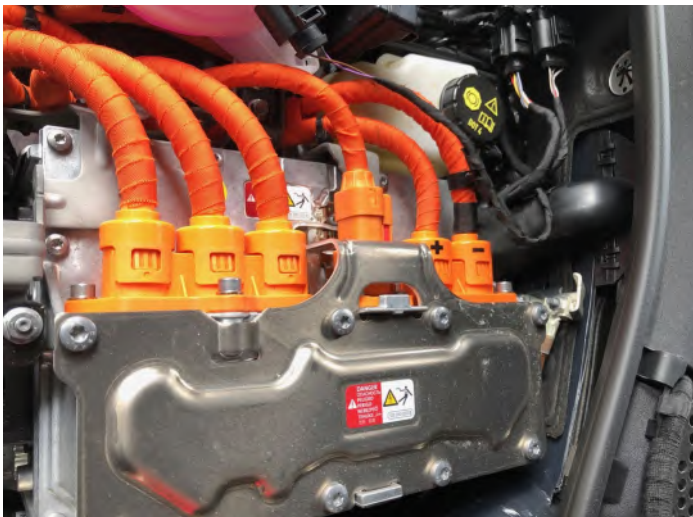
Abb. 2 Basisschutz durch Isolation und Abdeckung
