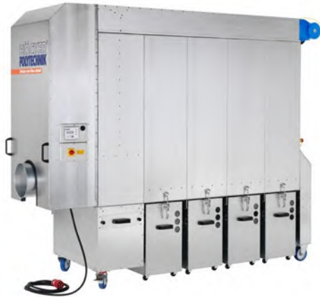
Abb. 4.1.7 Entstauber als vollständiges Kompakt-Gerät
