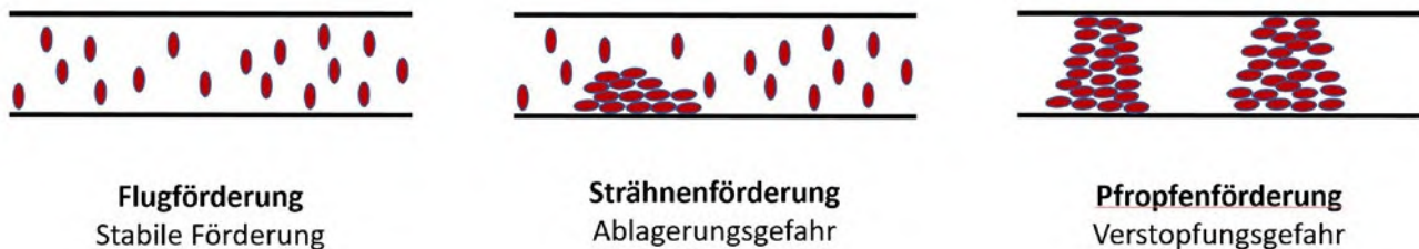
Abb. 3.3.3 Arten der Förderung von Stoffen in Rohrleitungen
