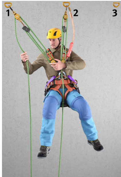
Abb. 11b Person positioniert sich mit zwei Tragsystemen (hier grün)
