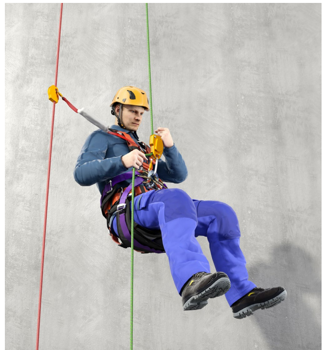
Abb. 3 Beispiel eines Arbeitssitzes
