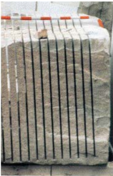
Abb. 9: Mit Haltebügel gesicherte Steinplatten
