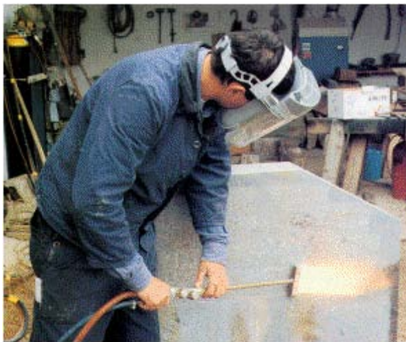
Abb. 28: Gebläseunterstützte Atem-Schutzmaske beim Flämmen
