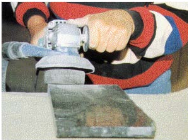
Abb. 31: Winkelschleifer mit Absaughaube
