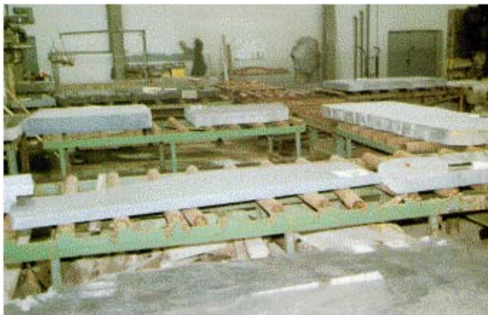
Abb. 22: Rollenbahnen für Zwischentransporte
