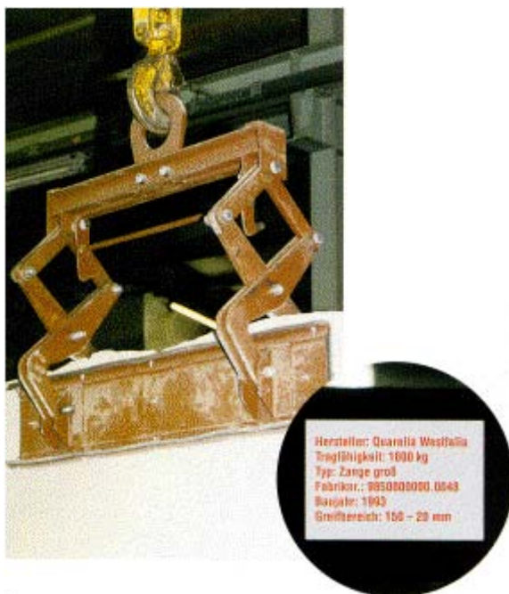
Abb. 14: Plattenzange mit Kennzeichnung
