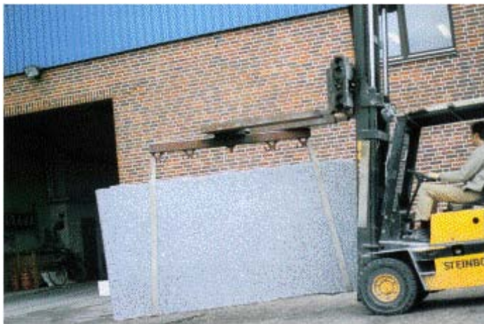
Abb. 18: Plattentransport mit Stapler und Hebebändern
