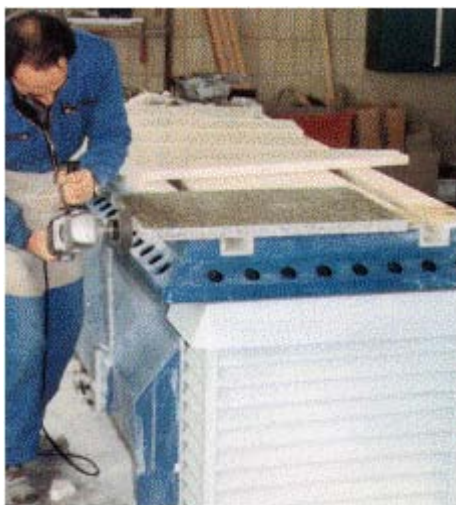
Abb. 32: Schleifarbeiten am Absaugtisch
