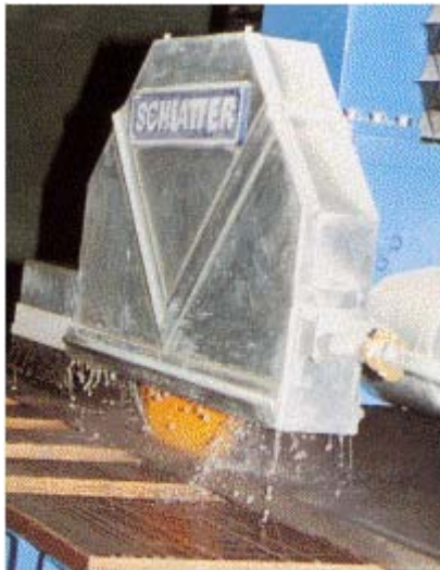
Abb. 36: Schutzhaube und Spritzschutz an einer Brückensäge
