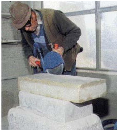
Abb. 30: Trennscheibe mit Absaugeinrichtung
