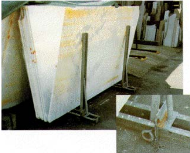
Abb. 15: Hilfstützen am A-Bock-Lager
