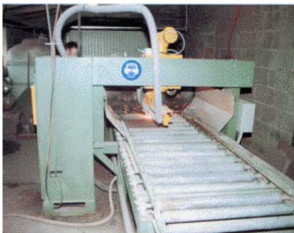
Abb. 38: Flämmanlage zur Oberflächenbearbeitung
