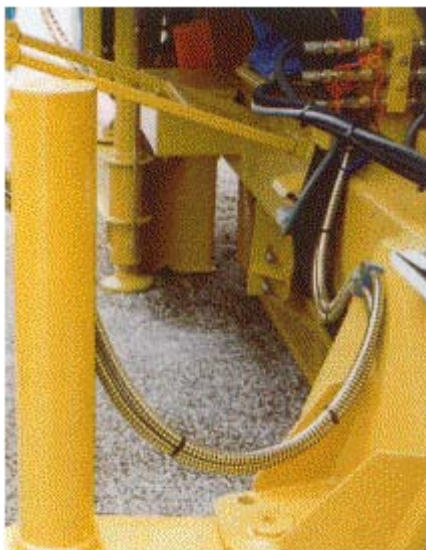
Abb. 19: Gegen Beschädigungen geschützte Hydraulikschlauchleitung
