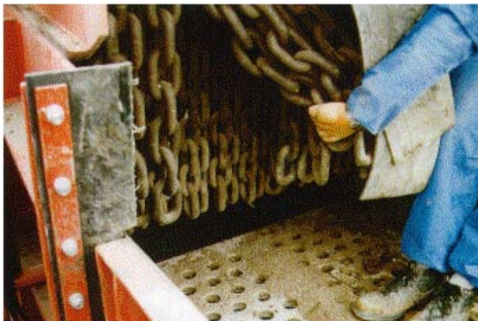
Abb. 16: Kettenvorhang zum Schutz gegen zurückschleudernde Teile
