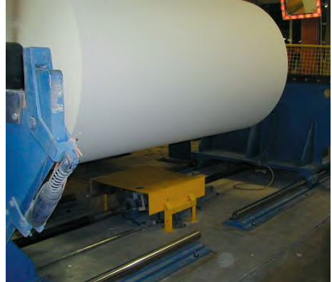
Abb. 3 Die Engstelle zwischen Tambour und der gelben Schutzeinrichtung am Boden ist leicht erreichbar. Es muss deshalb ein Sicherheitsabstand von 500 mm eingehalten werden.
