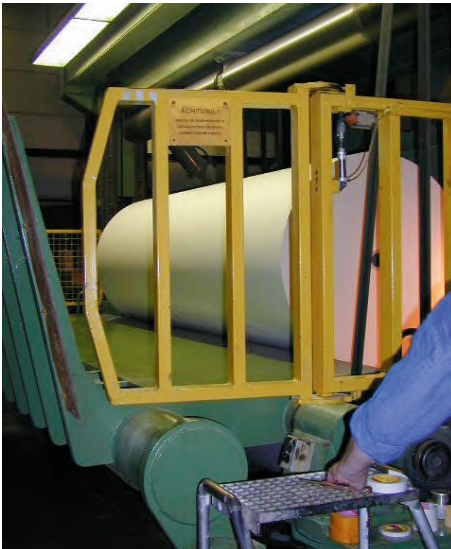
Abb. 6 Die hochgestellte Absenkbühne verwehrt gemeinsam mit den seitlichen Türen den Zugang zu den Einzugsstellen des laufenden Rollenschneiders.
