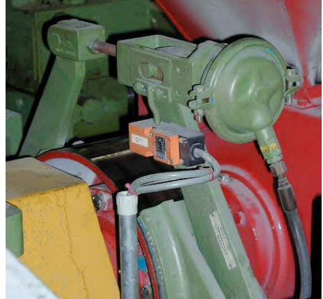
Abb. 1 Diese Bremse ist als Feststellbremse ausgelegt. Versuche haben ergeben, dass sie keinen Schaden nimmt, wenn sie zusätzlich zur Betriebsbremse bei etwa 20 m/min oder weniger durch einen Not-Halt-Befehl aktiviert wird, wodurch sich der Nachlauf zum Teil drastisch verkürzen lässt.
