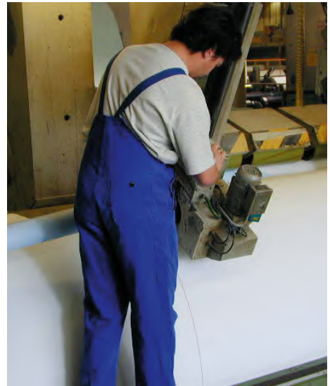
Abb. 7 Der Bediener spannt eine neue Hülse ein. Während er mit der linken Hand die Hülse führt, fährt er mit der rechten die Spannkone mit dem Tipptrieb ein.
