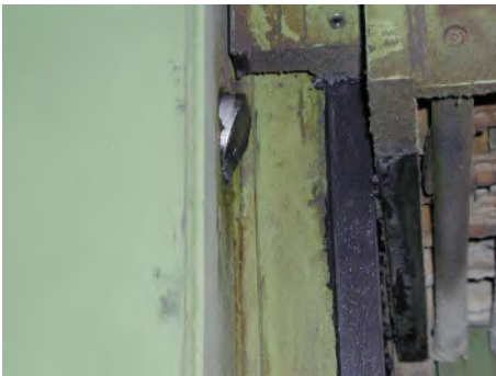
Abb. 5 Die Andruckwalze ist in oberer Endstellung. Ein ausgefahrener Bolzen auf jeder Maschinenseite hält sie bei Ausfall des Tragmittels in oberer Stellung.
