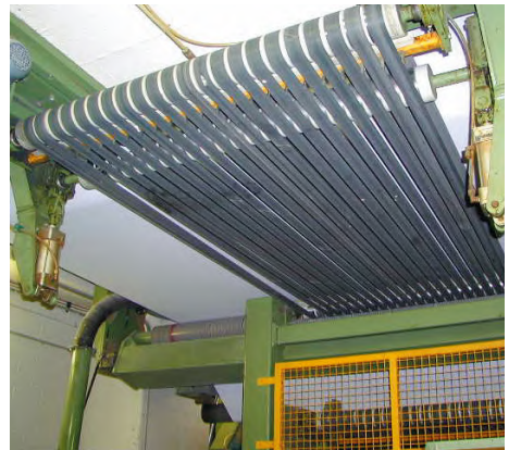
Abb. 2 Eine Bänderführung führt die Bahn durch den Keller, ohne dass von Hand eingegriffen werden muss. Von Hand erreichbare Bandaufläufe sind durch eine Schutzstange gesichert
