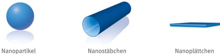
**Nanostrukturierte Materialien** haben eine nanoskalige innere Struktur oder Oberflächenstruktur und treten als Verbundsysteme von Nanoobjekten auf.
