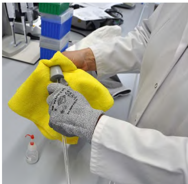
Abb. 8 Sicheres Durchführen eines Glasrohrs durch einen Stopfen
