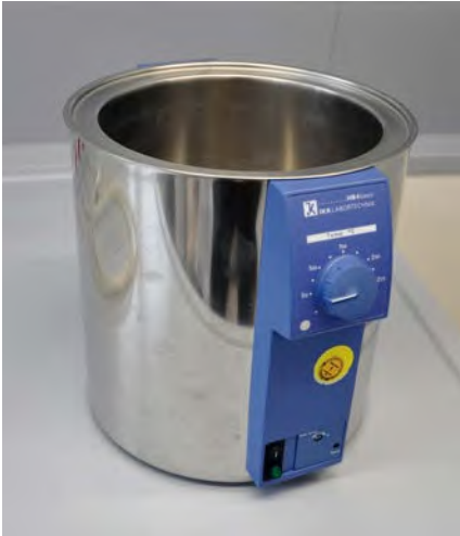
Abb. 15 Standardheiz- quelle im Labor für ein sicheres Heizen ist ein regelbares Heizbad
