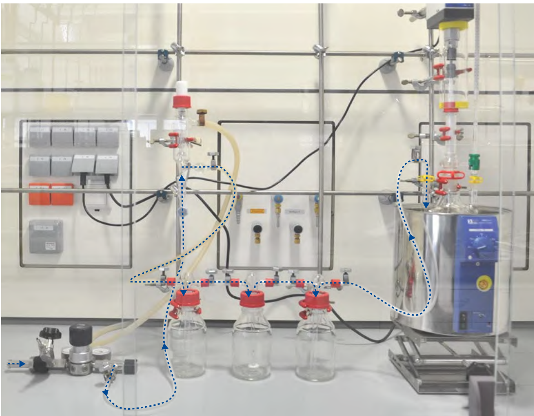
Abb. 30 Einleiten von Gasen mit Überdruckventil
