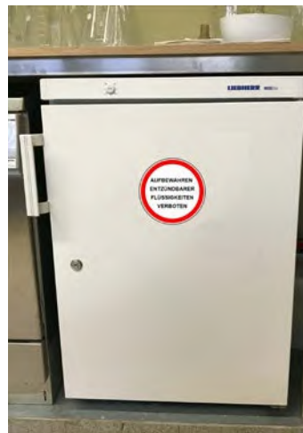
Abb. 21 und 21a Kühlschränke, die nicht für die Aufbewahrung entzündbarer Flüssigkeiten geeignet sind, sind mit einem Aufkleber zu kennzeichnen
