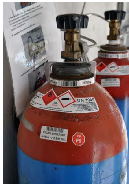
Abb. 23 Korrosionsschäden an Druckgasflaschen
