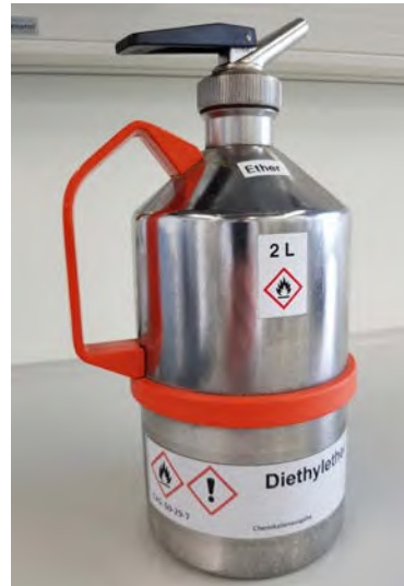
Abb. 44 Sicherheitsbehälter mit Flammenrückschlag- sperre und Druckent- lastung
