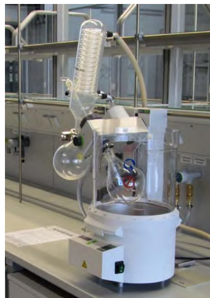
Abb. 19 Rotationsverdampfer mit beschichtetem (polycoated) Kühler und Auffangkolben
