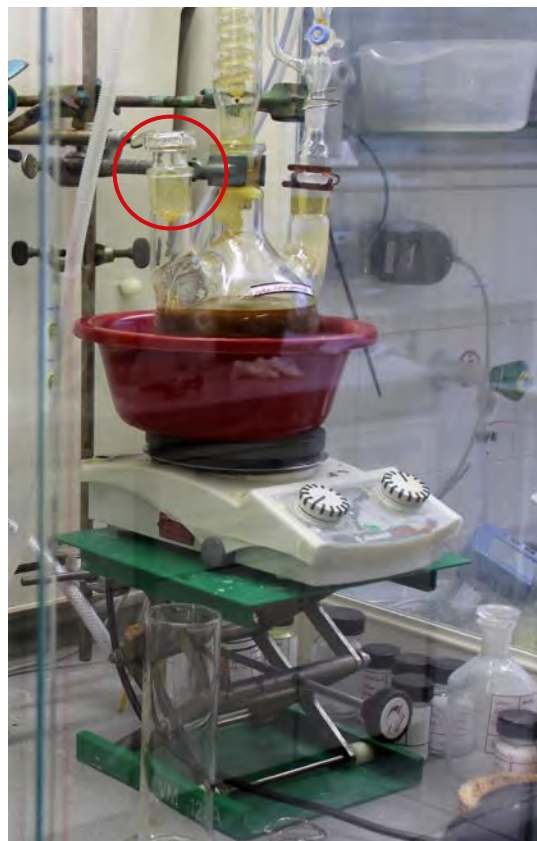
Abb. 11 Ist eine Überdrucksicherung nicht verfügbar, ist es empfehlenswert, einen an einer unkritischen Stelle befindlichen Schliff nicht zu klammern, damit sich dort im Fall eines Druckaufbaus eine Notöffnung bilden kann.
