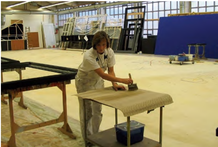
Abbildung 18: Behandeln von Gegenständen mit Flammschutzmitteln im Streichverfahren (Friedrich)
