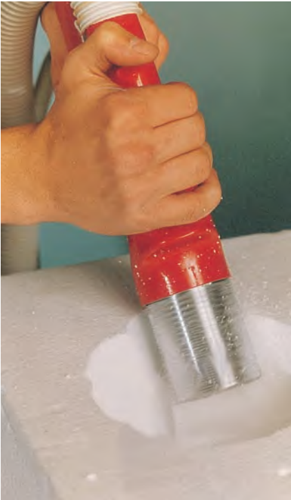
Abbildung 8: Abgesaugter Hohlfräser bei der Bearbeitung von Polyesterschaumstoff (Fa. ZEITEC)
