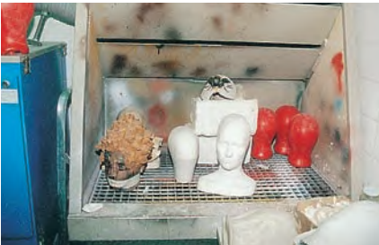
Abbildung 10b: Absaugeinrichtung zur Herstellung von Glatzen und Masken (Landmann)
