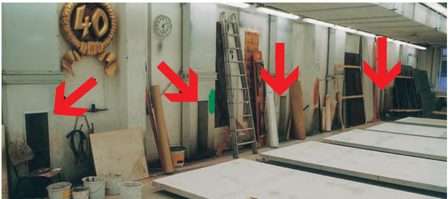
Abbildung 2: Randabsaugung im Wandbereich (siehe rote Pfeile) (Robrecht)
