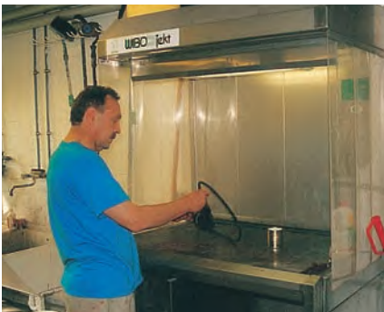
Abbildung 4: Abgesaugter Reinigungstisch: Die Lösemittel laufen über einen Filter in den Behälter zurück; die Lösemitteldämpfe werden abgesaugt (Heidekorn)
