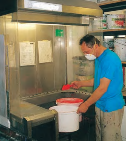
Abbildung 6: Umfüllen von pulverförmigen Farbstoffen an einem abgesaugten Arbeitstisch (Heidekorn)
