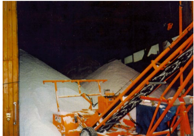
Abb.9 Streuguthalle mit Salzladeförderbandt
