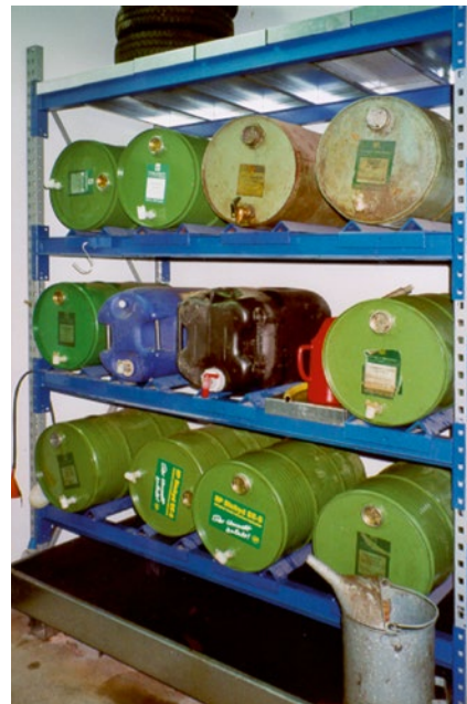
Abb. 6 Schmierstofflager mit Auffangwanne
