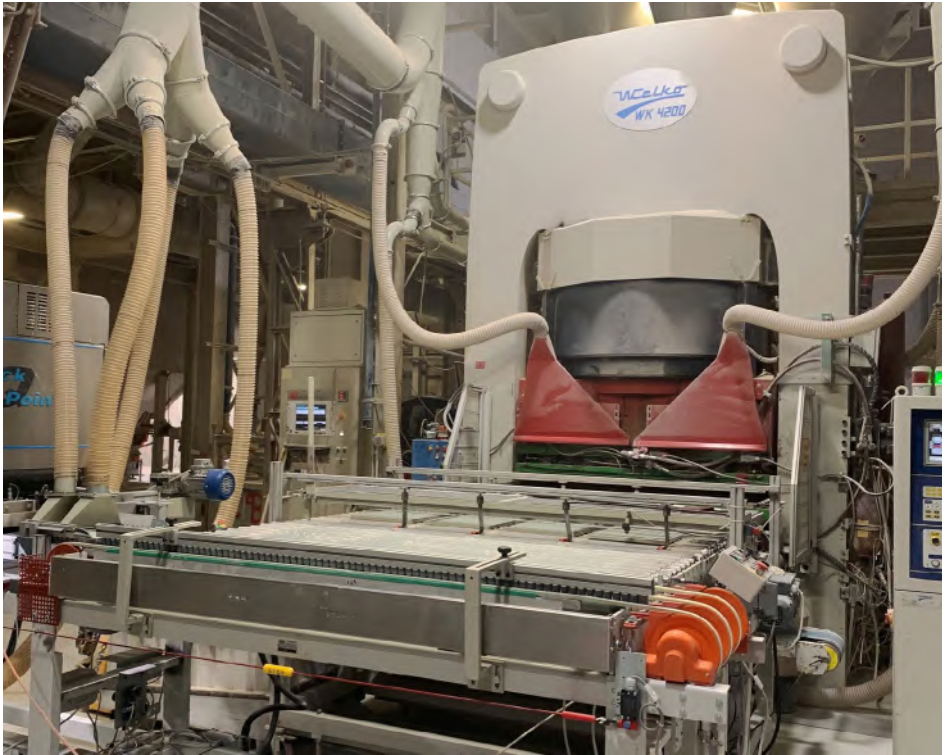
Abb. 20 Fliesenpresse mit Absaugung und Erfassungseinrichtungen
