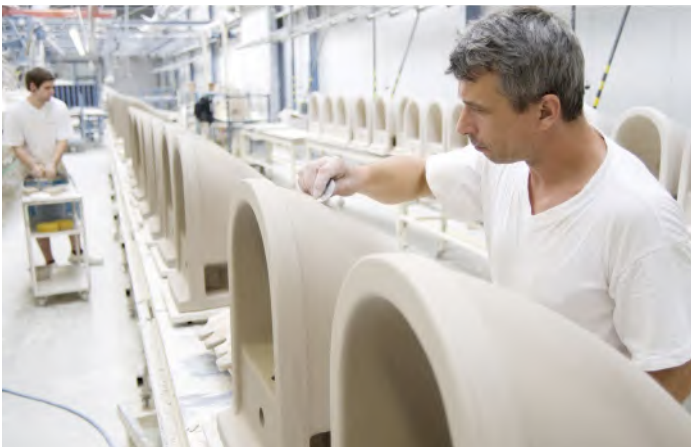
Abb. 5 Abschleifen von Übergängen und Kanten an Wasser- klosetts
