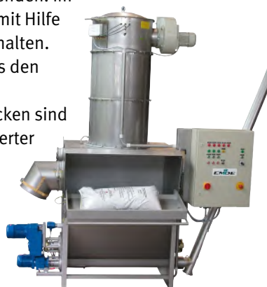
Abb. 17 Sackentleerstation mit integrierter Absaugung
