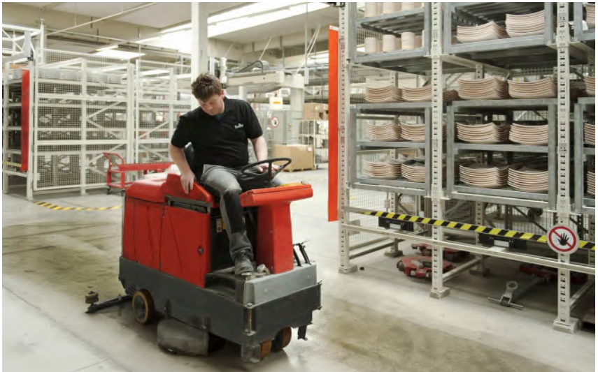
Abb. 15 Feuchte Bodenreinigung mit Scheuersaugmaschine
