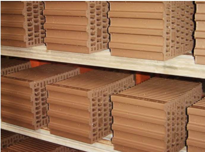
Abb. 3 Zum Trocknen bereitgestellte Hintermauerziegel
