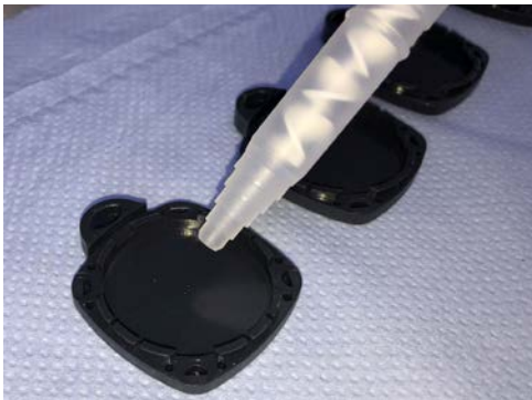
Abb. 37 Mischung von Epoxidharzsystemen in einem Mischrohr einer Doppelkartusche für die Herstellung von Transpondern als Schlüsselanhänger
