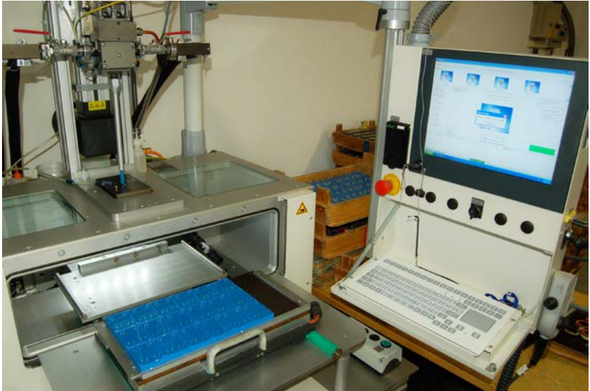
Abb. 20 Baugruppen nach dem Verguss mit Epoxidharzen
