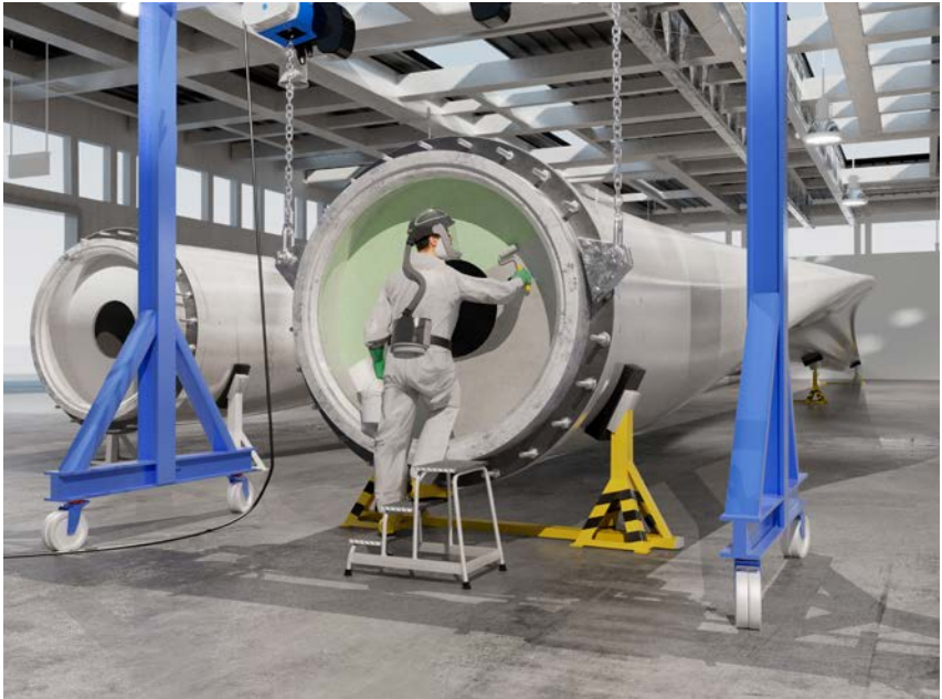
Abb. 42 Ausbesserungsarbeiten mit lösemittelhaltigen Epoxidharzsystemen an der Innenoberfläche eines Rotorblattes einer Windenergieanlage
