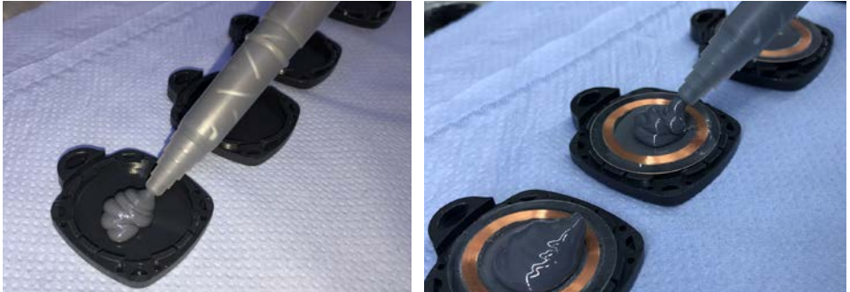
Abb. 38 a, b Auftragung von Epoxidharzsystemen auf die Gehäuseunterschale mithilfe einer Doppelkartusche
