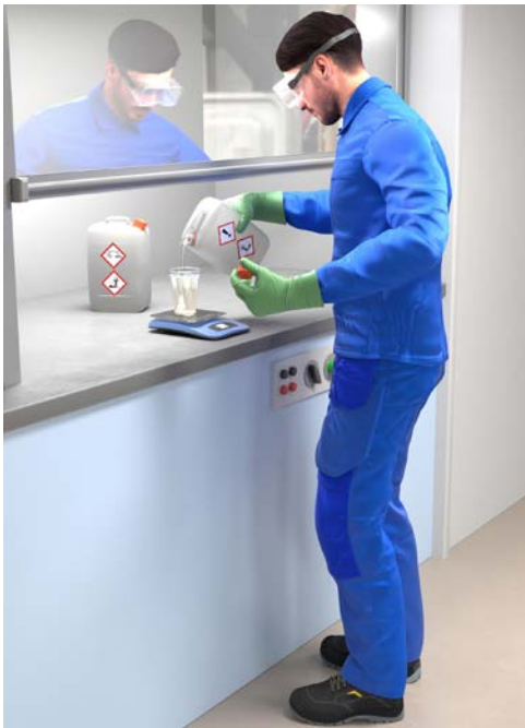
Abb. 14 Abwiegen von Epoxidharzsystemen
