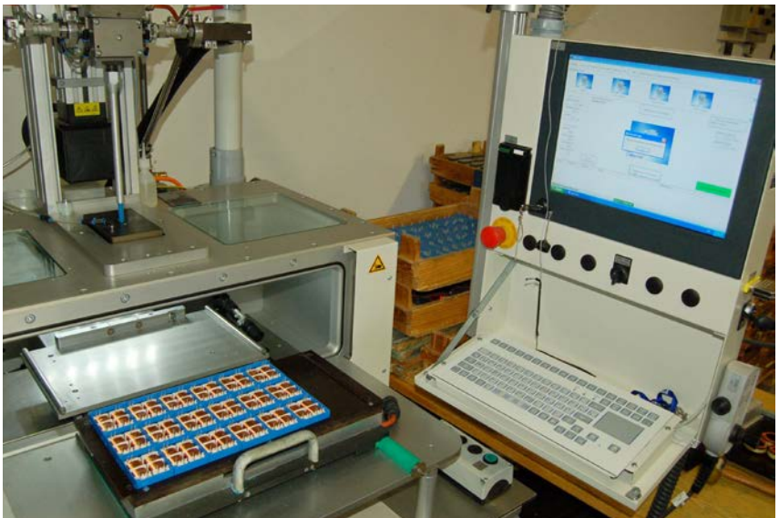
Abb. 19 Für den Verguss vorbereitete Baugruppen
