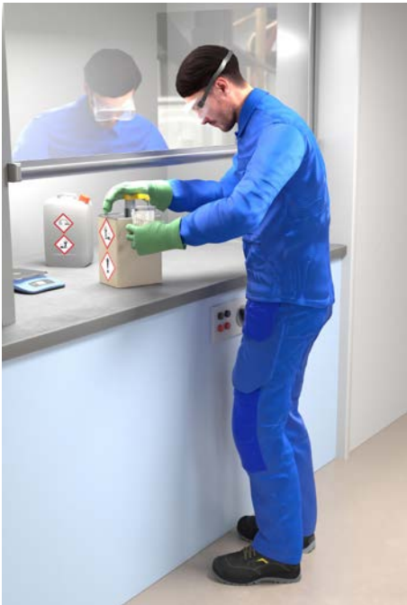
Abb. 15 Dosieren von Epoxidharzsystemen
