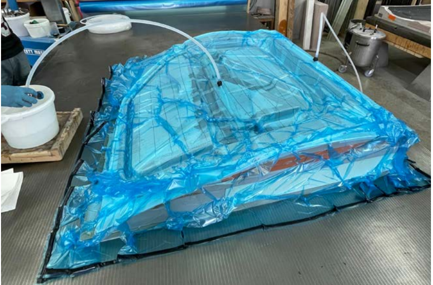
Abb. 31 Vakuuminfusionsverfahren: Das Harz wird mittels Unterdruck über einen Kunststoffschlauch aus der Mischvorlage in die Form befördert.
