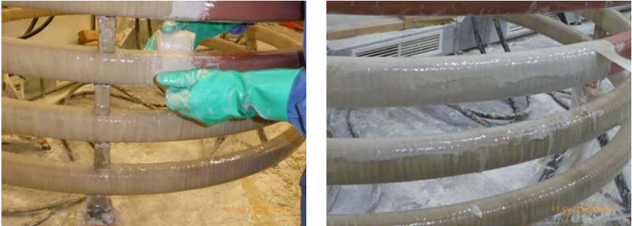
Abb. 34 a, b Umwickeln der Spulen mit epoxidharzgetränktem Gewebeband
