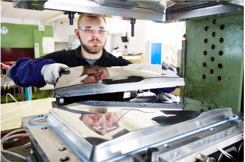
Abb. 32 Im RTM-Verfahren wird das Bauteil in einer Form unter Druck und Wärme ausgehärtet.
