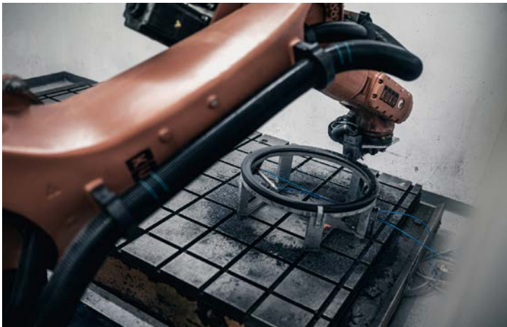
Abb. 41 robotergestützte Schleif- und Fräsarbeiten
