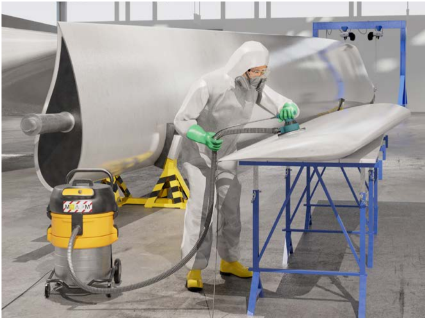
Abb. 40 Bearbeitung der Oberfläche eines Rotorblattbauteils einer Windenergieanlage mittels Flächenschleifer
