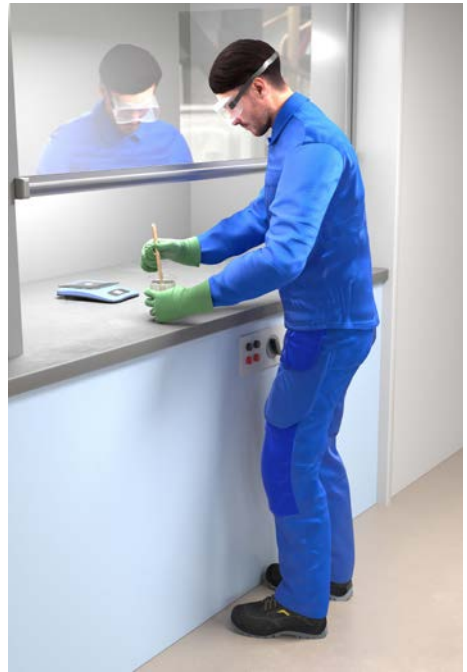
Abb. 16 Mischen von Epoxidharzsystemen
