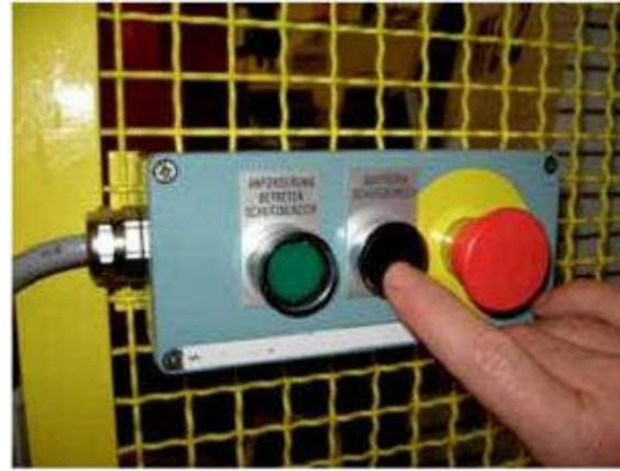
Bei weiträumigen Anlagen sollten zusätzlich zu den Quittiereinrichtungen Sicherungsmöglichkeiten für Instandhalter vorgesehen werden, z. B. durch die Möglichkeit zum Einhängen von Schlössern (Lock Out) oder gleichwertigen personengebundenen Sicherungseinrichtungen.
