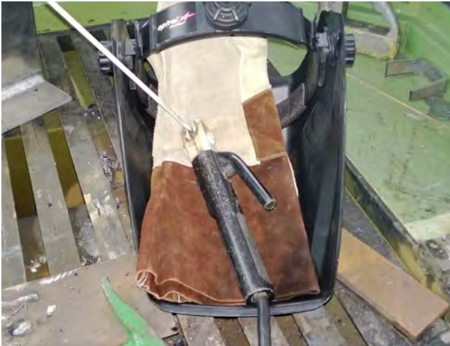
Abb. 6-4 Stabelektrodenhalter immer isoliert ablegen
