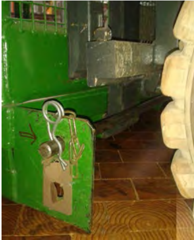
Abb. 4-6 formschlüssige Sicherung gegen Abrutschen
