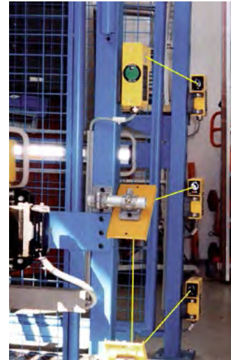
Abb. 3-7 Lichtschranke als Beispiel für eine Schutzmaßnahme Rang 2
