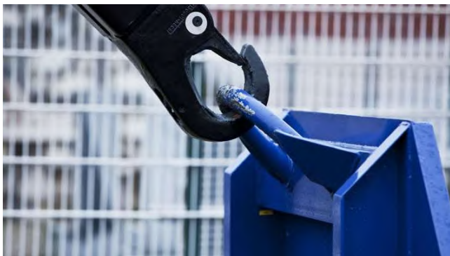
Abb. 7 Hakenausleger mit hydraulischer/ pneumatischer Sicherung
