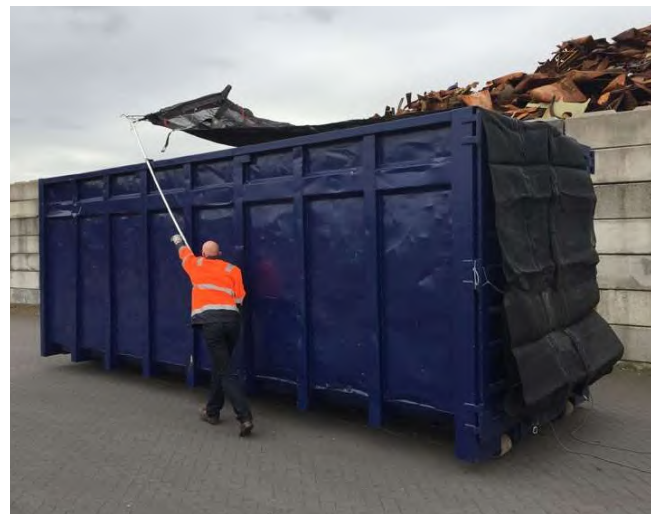
Abb. 37 Manuelles Abdecksystem mit einer Stange und Laufrad
