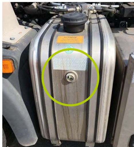
Abb. 10 Hydraulikanlage mit Füllstandanzeige
