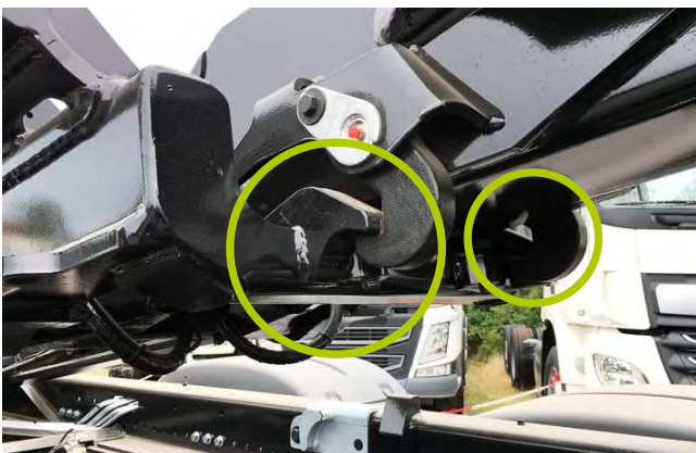
Abb. 11 Durch-Knick-Sicherung (Greifhaken) mit einer über die Federkraft wirkenden Ausleger-Verriegelung
