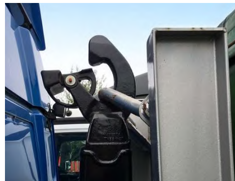
Abb. 8 Aufnahmehaken mit Schwerkraftsicherung
