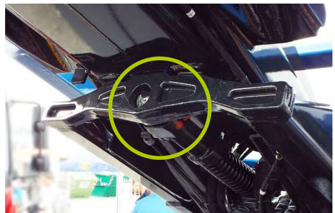
Abb. 12 Durch-Knick-Sicherung (Bolzen) mit einer über die Federkraft wirkenden Ausleger-Verriegelung
