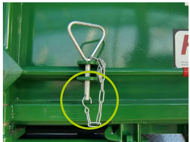
Abb. 29 Gesicherter Verschluss am Abrollbehälter
