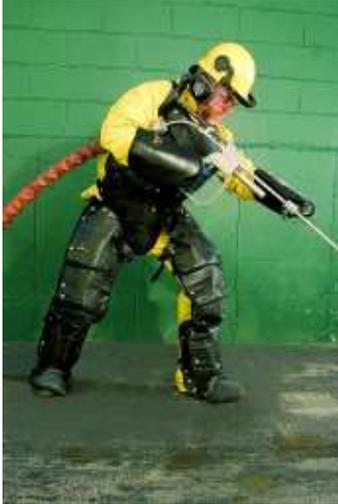
**Abb. 3-11: Als modulare "Rüstung" ausgeführte Schutzbekleidung gegen Verletzungen durch Hochdruckwasserstrahl, über oder unter Regenschutzbekleidung zu tragen.**
