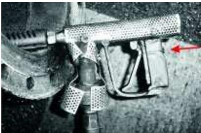
Abb. 3-3: Auf frischer Tat! Der bei einer Unfalluntersuchung gefundene Draht hatte einen Industriereiniger einen halben Fuß gekostet.
