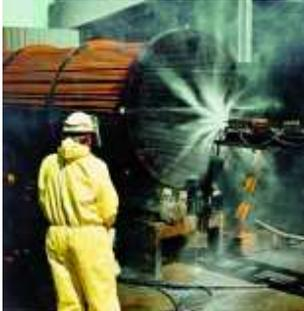
**Abb. 3-5: Röhrenbündelwärmetauscher, Reinigungsgerät. Für wiederkehrende Arbeiten sollten automatisierte Lösungen gesucht werden: dies ist die effektivste Maßnahme zur Minimierung der Gefährdung.**
