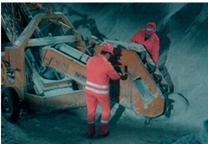
Salzladeförderband mit Becherwerk
