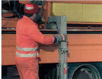
Entfernen der Stützen eines Streuautomaten
