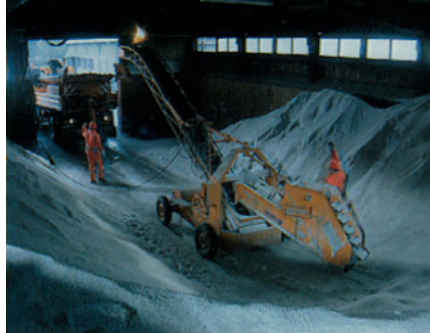
Beladen eines Winterdienstfahrzeuges mit dem Förderband
