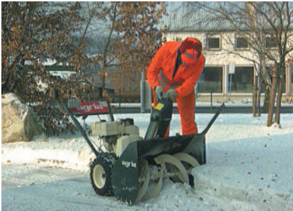
Einsatz des Stößels zum Beseitigen von Schneeverstopfungen
