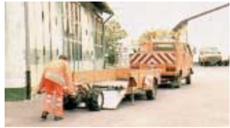
Auffahren eines Einachsschleppers auf einen Niederfluranhänger über eine speziell dafür konstruierte Bordwand.
