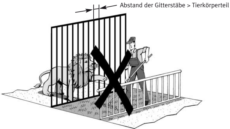
Bild 22: Unzulässige Arbeitsweise bei Arbeiten hinter der Umwehrung
