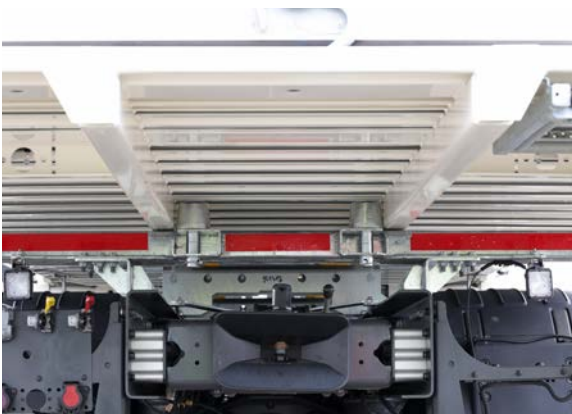
Abb. 25 Führungsrollen laufen bestimmungsgemäß im Führungstunnel
