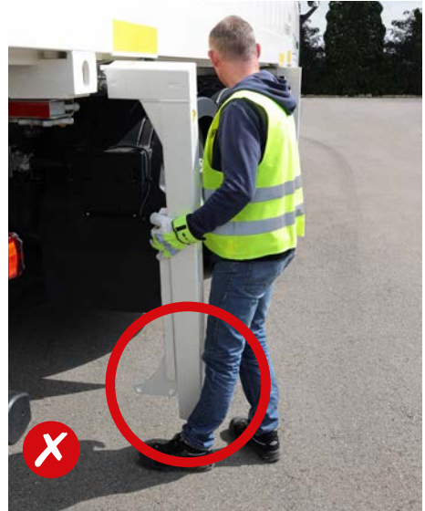
Abb. 11 Achtung: Verletzungsgefahr im Schwenkbereich!
