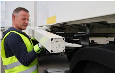
Abb. 8 Stützbein mit Stützbeinstrebe mit beiden Händen herausziehen
