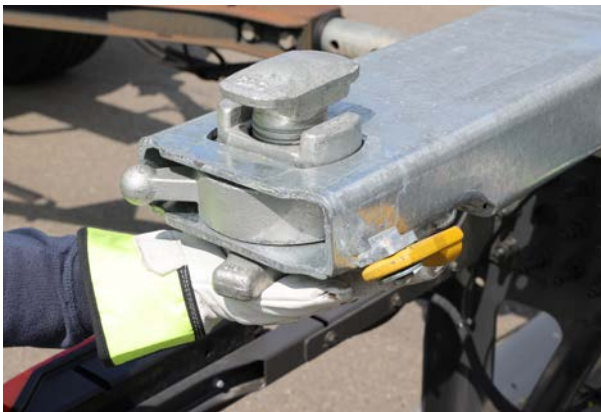
Abb. 26 Spannmutter anheben und Drehzapfen drehen
