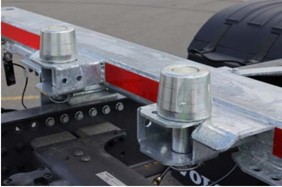
Abb. 23 Führungsrollen am Fahrzeugaufbau
