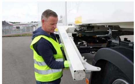
Abb. 9 Stützbein mit Stützbeinstrebe herabschwenken
