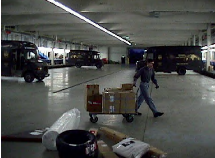
Bild 13 Ladehalle ohne technische Lüftungsanlage Durch Offenhalten der gegenüberliegenden Andocköffnungen wird eine Querlüftung erreicht.
