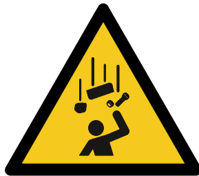
Abb. 33 Gefahr von Material verschüttet oder getroffen zu werden (DIN EN 16486:2014-10, Bild 9)
