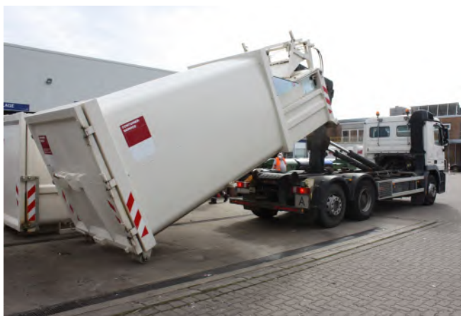
Abb. 2 Mobile Behälterpresse mit horizontalem Pressschild für ein Abrollkipperfahrzeug
