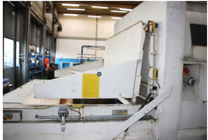
Abb. 7 Behälterpresse mit erhöhtem Einfüllrand als Sicherheitsbarriere bei einem Einfüllrand < 1500 mm
