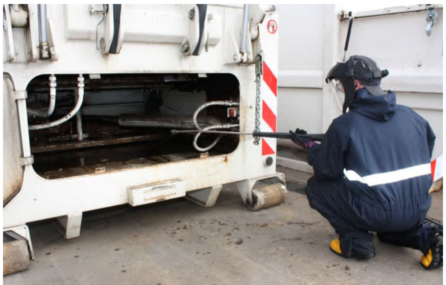
Abb. 12 Reinigung des Arbeitsraums mit Hochdruckwasserstrahl
