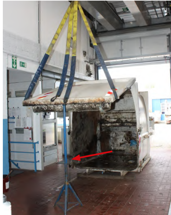
Abb. 27 Sicherung einer angehobenen Entladungstür
