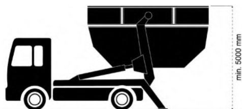
Abb. 38 Rangierhöhenbedarf für Absetzkipper
