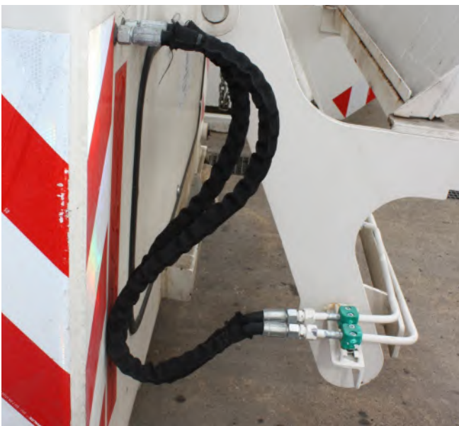
Abb. 23 Berstschauch über Hydraulikleitungen
