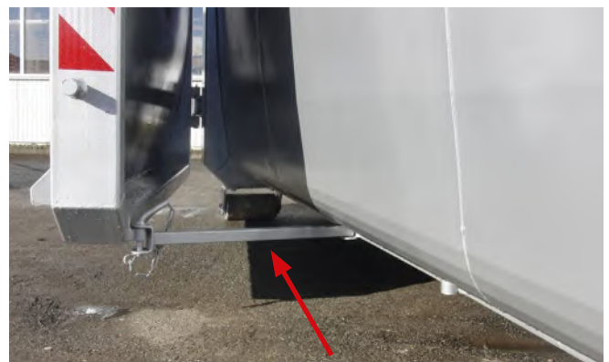
Abb. 24 Sicherung der Entladungstür am geöffneten Behälter
