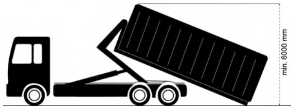
Abb. 37 Rangierhöhenbedarf für Abrollkipper
