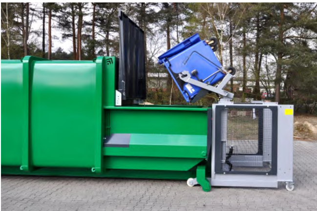
Abb. 15 Trennende Schutzeinrichtung an externer Hub-Kippvorrichtung
