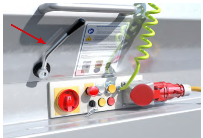
Abb. 14 Stellhebel für eine Kippvorrichtung mit darüberliegendem Schutzbügel
