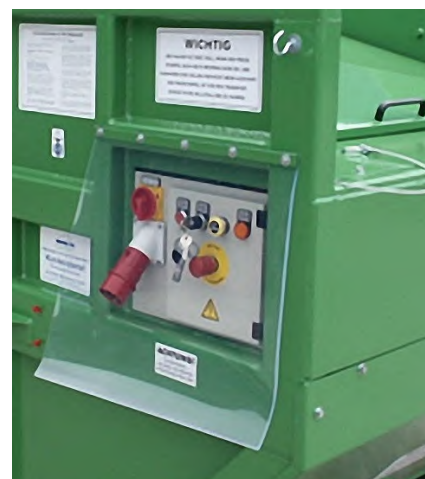
Abb. 19 Spritzschutz durch einen Abweiser
