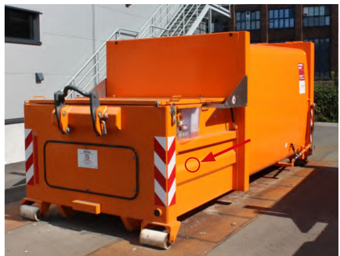
Abb. 9 Abgeschrägter Querspannt; Aufstieg erschwert
