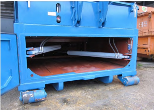
Abb. 10 Wartungs- und Reinigungszugang
