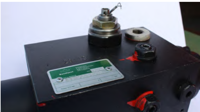
Abb. 22 Druckbegrenzungsventil mit einer Plombe
