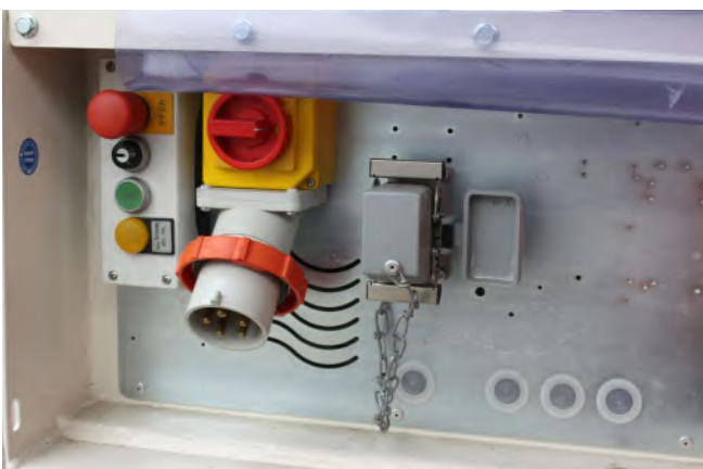
Abb. 18 Steuerelement mit Anschluss für kabelgebundene Fernbedienung
