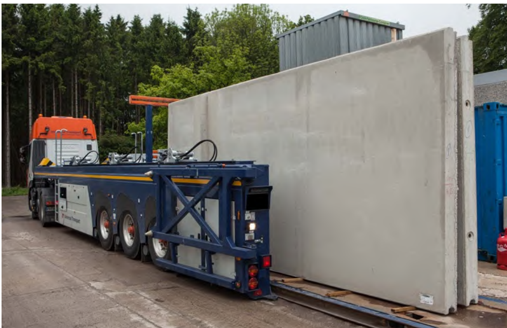
Abb. 2: Aufnehmen einer beladenen IP mit dem Innenlader-Fahrzeug
