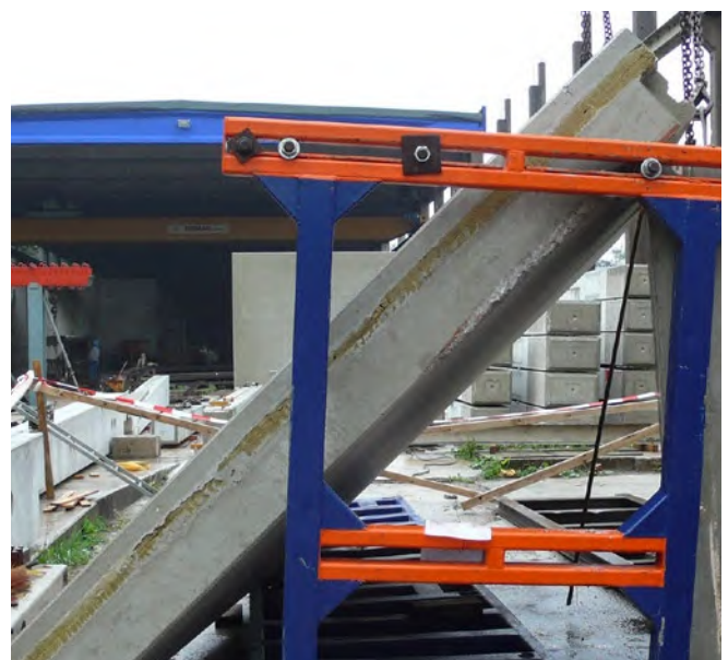
Abb. 11: Umsturz der Last durch Einwirken äußerer Kräfte
