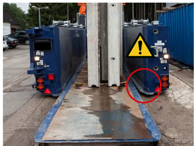
Abb. 24: Scherstelle zwischen IP und Innenlader-Fahrzeug
