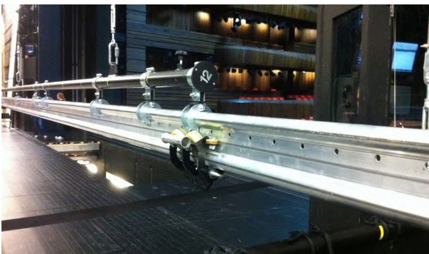
Abb. 3 Schienensystem und Laufwagen für manuelles Fliegen von Personen
