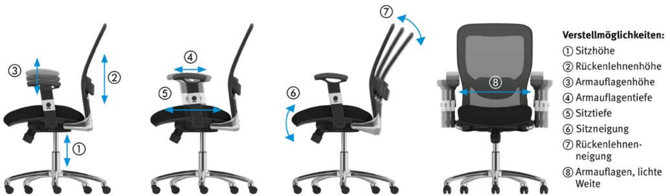
Abb. 34 Verstellmöglichkeiten an einem Büroarbeitsstuhl
