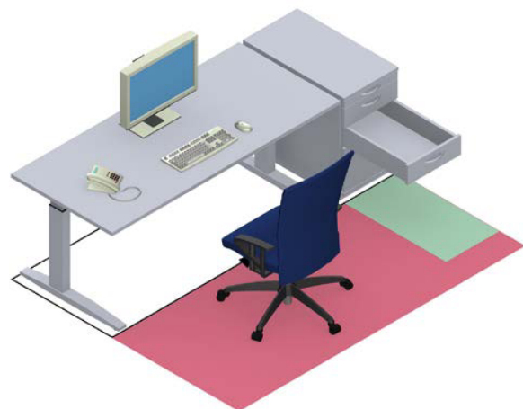
Abb. 13 Zulässige Überlagerung von Bewegungs-/Benutzerflächen und Funktionsfläche
