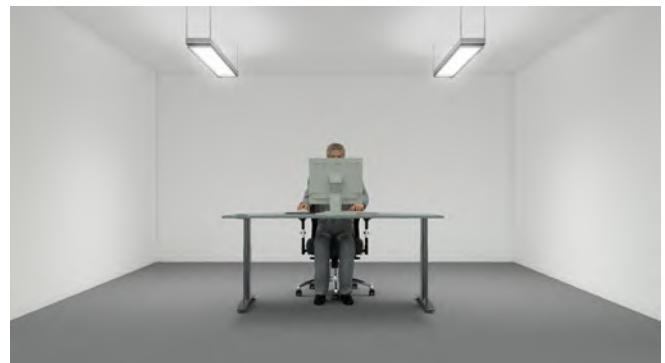
Abb. 19 Beispiel für Direkt-/Indirektbeleuchtung
