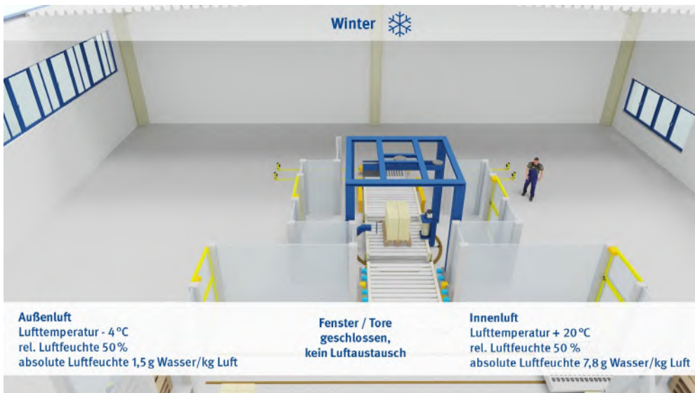
Abb. 5 Luftfeuchte vor dem Lüften
