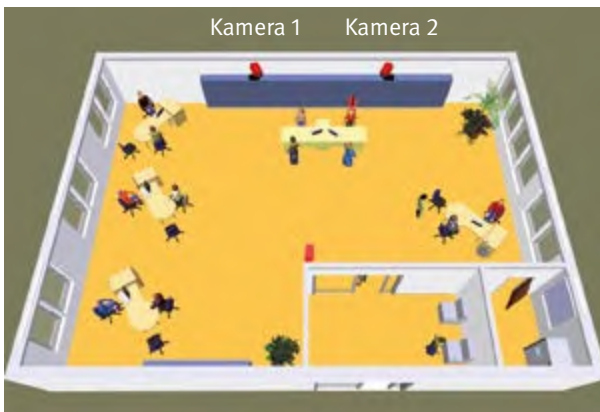
Abb. 2 Installationsbeispiel für Videokameras in einer BBA-Stelle
