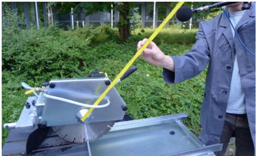
Abb. 9 Brückensäge mit 350 mm-Trennscheibe
