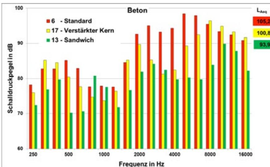
Abb. 16 Terzbandspektren am Arbeitsplatz beim Sägen von Beton (350 mm Sägeblatt) bei Einsatz von Standard-Trennscheibe (rot), Trennscheibe mit verstärktem Kern und Lochung (gelb) und Sandwich-Trennscheibe (grün)
