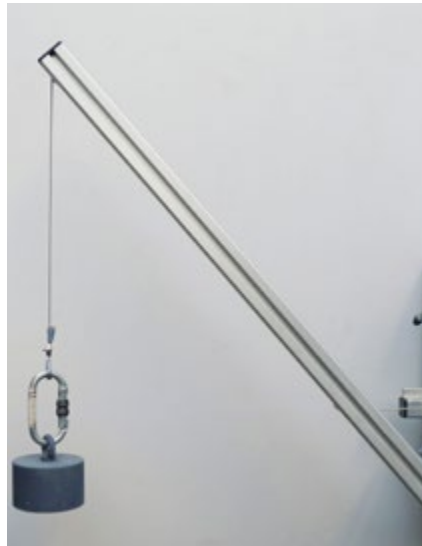
Abb. 10 Vorschub des Materials über Seilzug und angehängtes Gewicht (weißer Hintergrund nur für Foto)
