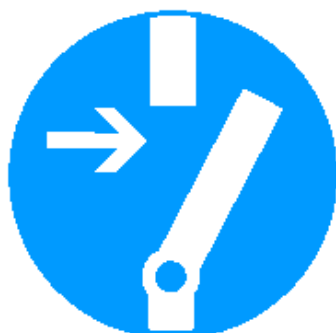
M014 Vor Arbeiten freischalten
