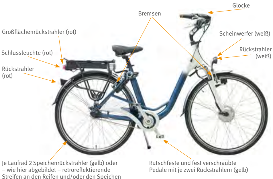
Abb. 7 Vorgeschriebene Ausrüstung des Pedelec 25
