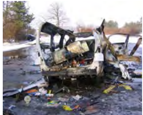
Abb. 9-1 Fahrzeug nach Druckgasflaschenexplosion
