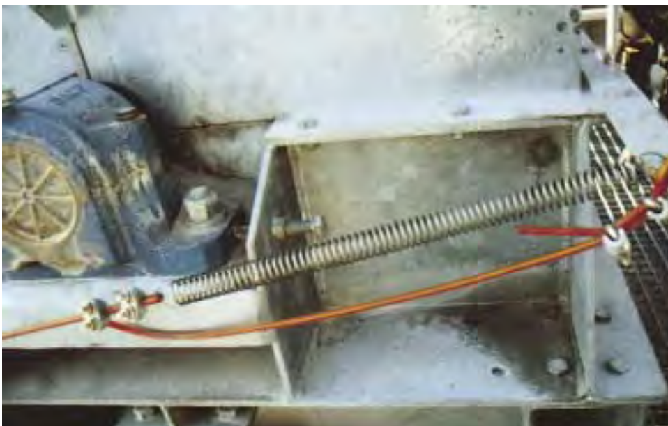
Abb. 19: Richtige Installation von Reißleinen
