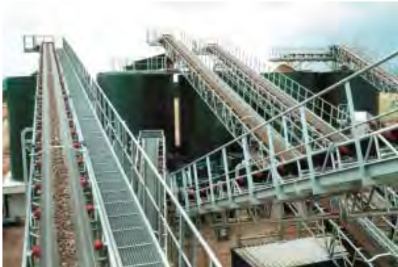
Abb. 22: Laufstege und Bühnen am Bandkopf
