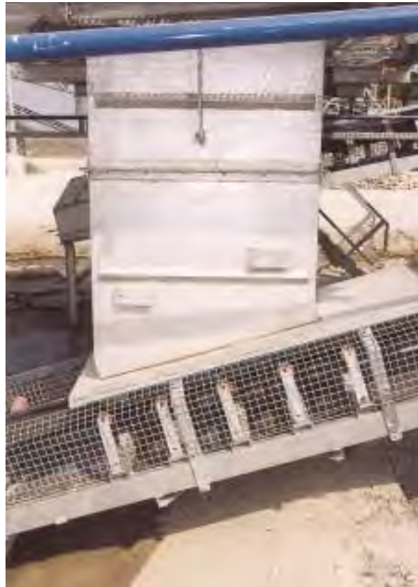
Abb. 12: Schutzgitter an Tragrollen
