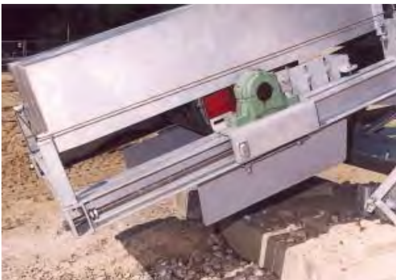
Abb. 7: Verdeckung der Spanntrommel mit Verstellmöglichkeit von außen
