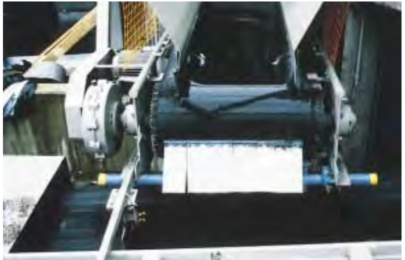
Abb. 24: Federbelasteter Lamellenabstreifer an einer Abwurfstelle
