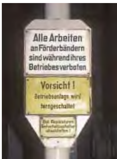
Abb. 45: Hinweisschild an ferngesteuerter Bandanlage
