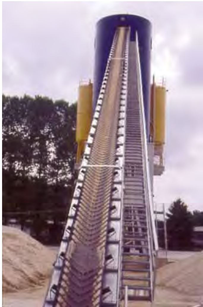
Abb. 23: Treppenaufgang neben einem Steilband
