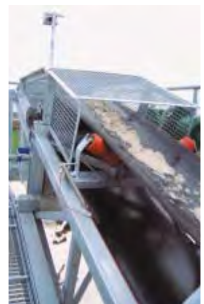
Abb. 5: Schutz-einrichtung an der Kopftrommel
