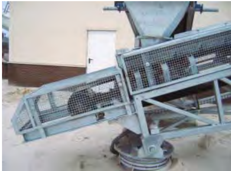
Abb. 6: Schutzeinrichtung an der Umlenktrommel
