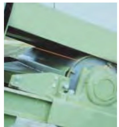
Abb. 9: Pflugabstreifer – zur Sicherheit und Reinigung
