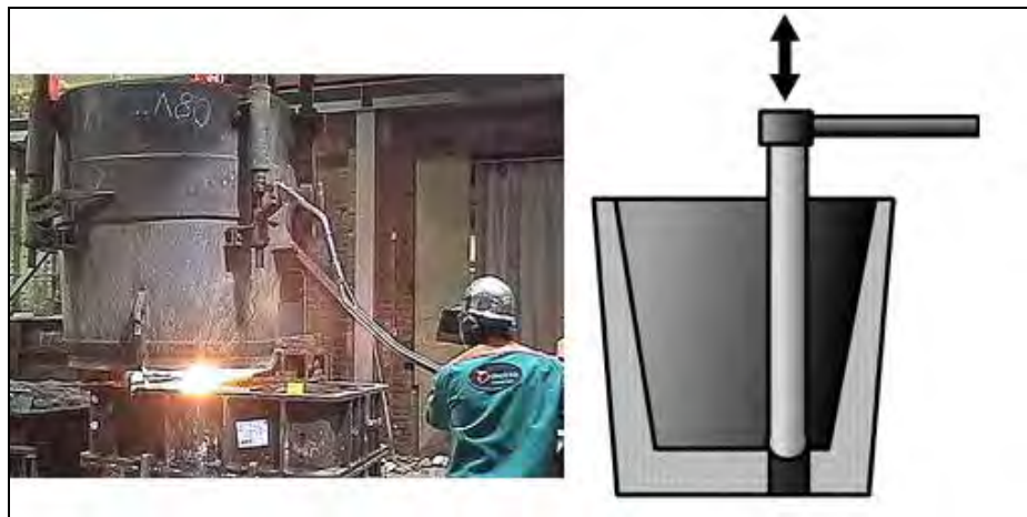
Figure 2.41: Bottom pour ladle for molten metal pouring [237, HUT, 2003]
