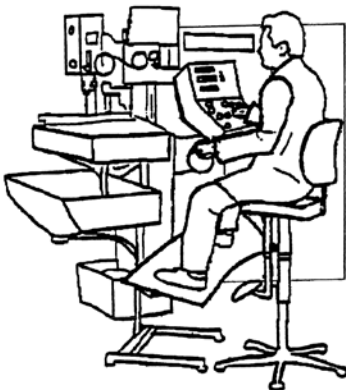
Abbildung 40: Beispiel für einen Arbeitsplatz mit erhöhter Sitzposition (Quelle: Bild 3 der DIN EN ISO 14 738:2008-12)
