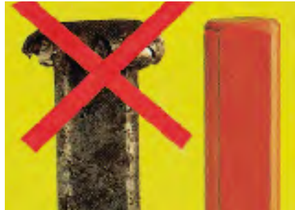
Meißelkopf – rechts fachgerecht angeschliffenes Schlagende
