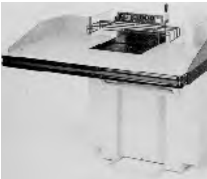
Sicherheitsabstand an einer Abfallzerkleinerungsmaschine durch großen Zuführtisch
