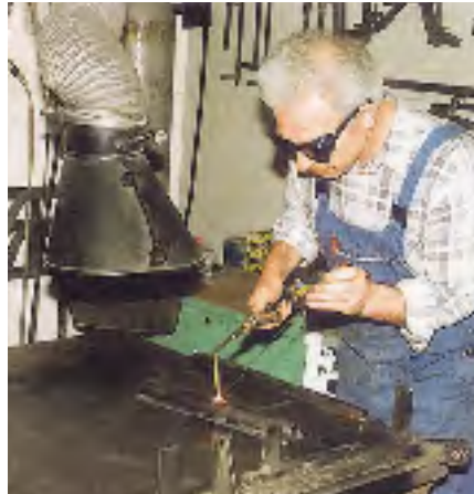
Absaugung der Schweißgase an der Entstehungsstelle
