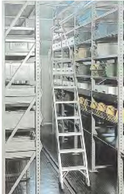
Bild 2: Rollleiter zum Arbeiten in zwei Regalen
