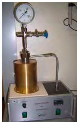
Bild 19a: Handautoklav mit Heizrührer
