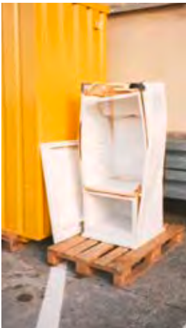
Bild 12: Folge der Verwendung eines nicht explosionsgeschützten Kühlschranks
