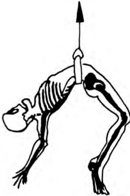
Bild 2: Gefahr der Wirbelsäulenverletzung bei der Benutzung von Haltegurten zum Auffangen
