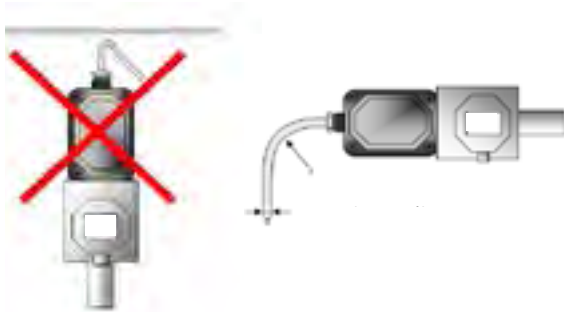
Abb. 27 Beachten eines ausreichenden Biegeradius
