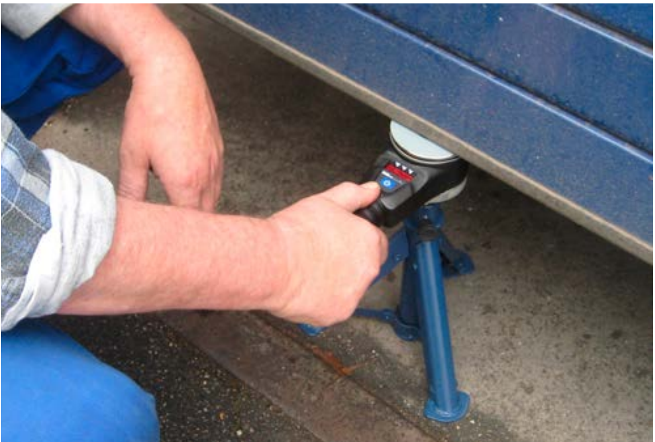
Abb. 25 Schließkraftmessung an der Hauptschließkante eines Torflügels
