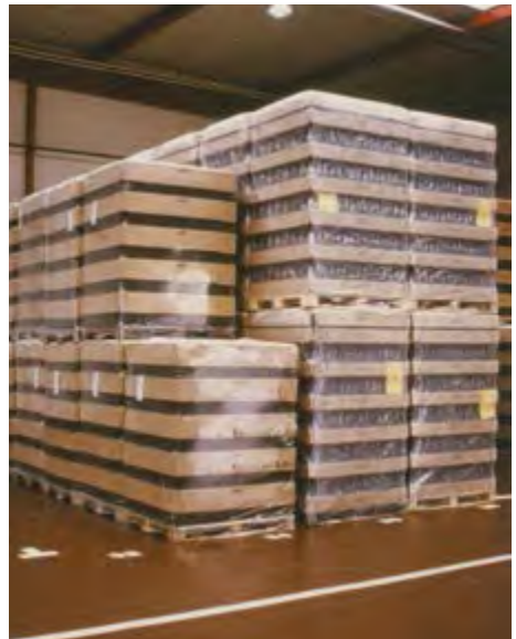
Abb. 12 Bei aus Lagen bestehenden Ladeeinheiten sind in der Regel weitere Maßnahmen zur Ladungssicherung erforderlich, z. B. das Anbringen von Schrumpfhauben.
