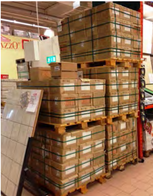
Abb. 17 Sicherung bei Säulen durch Umreifungen in alle Richtungen
