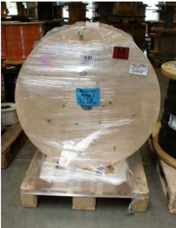
Abb. 27 Kanthölzer zur Sicherung gegen Abrollen
