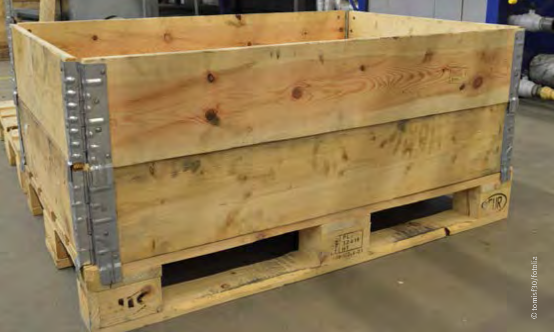
Abb. 23 Aufsetzrahmen ermöglichen unterschiedlich hohe Ladeeinheiten
