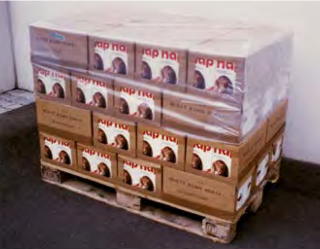
Abb. 9 Sicherung der oberen Lagen durch Kurzschrimpffhaube
