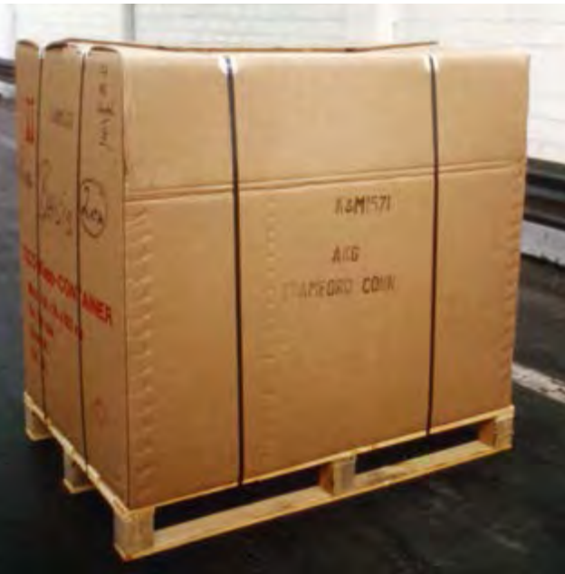
Abb. 7 Sicherung einer einstückigen Ladeinheit durch vertikale Stahlbänder
