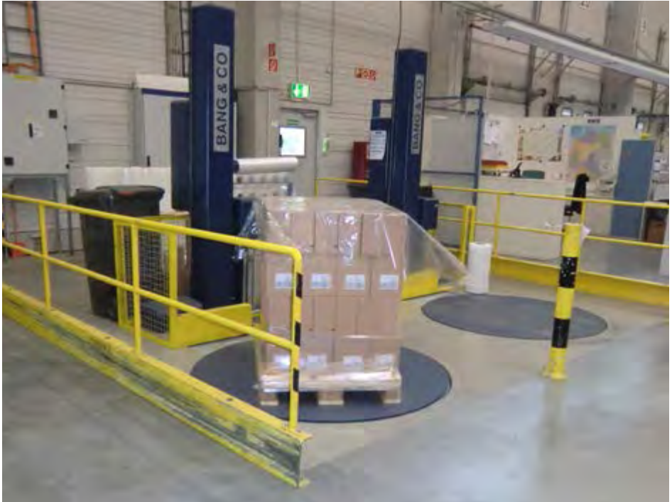
Abb. 6 Auf der Stretchmaschine wird in eine Folie durch mechanisches Dehnen eine Spannung eingebracht und die Folie in diesem Zustand mehrfach um die Ladeinheit gewickelt.
