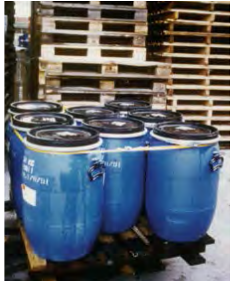
Abb. 13 Sicherung von Fässern durch Textilgurt mit Spannschloss
