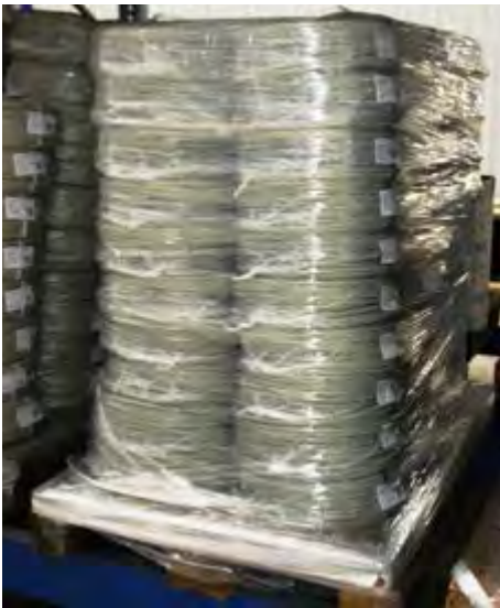
Abb. 16 Sicherung von Säulen aus Kabelrollen durch Stretchen
