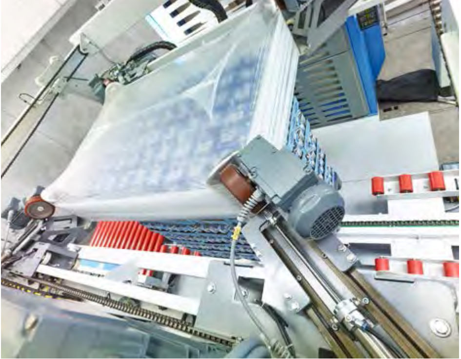
Abb. 5 Anlage zum Überziehen von Stretchhauben
