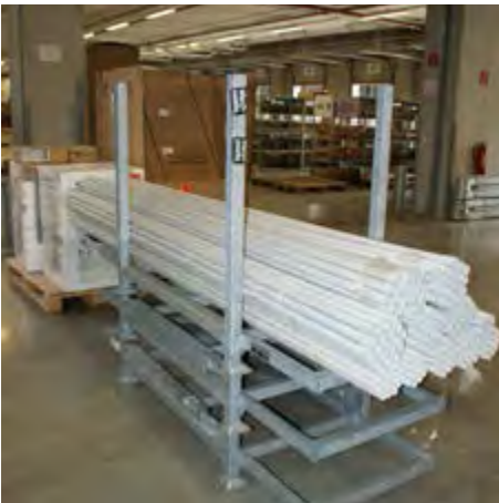
Abb. 19 Spezialpaletten für Kabelschutzrohre aus Kunststoff
