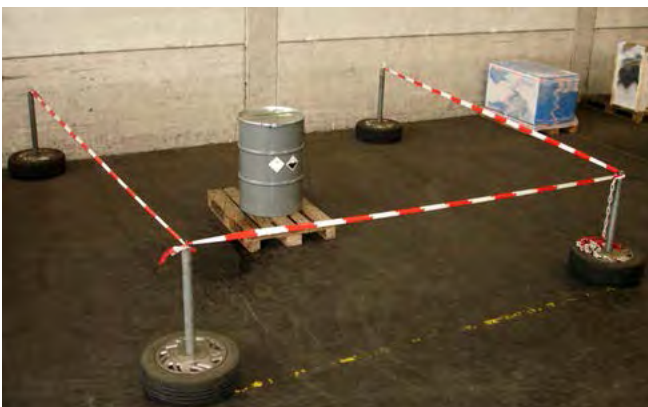
Bild 7: Absperrung des Gefahrenbereiches um ein beschädigtes Gebinde
