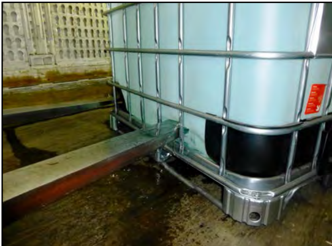
Bild 2: Beschädigung eines Gebindes durch die Gabelzinken eines Flurförderzeuges
