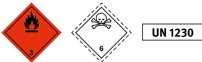
Bild 4: Gefahrgutrechtliche Kennzeichnung: Gefahrzettel und UN-Nummer Beispiel Methanol
