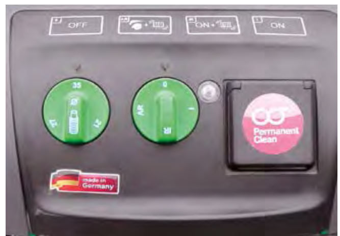
Abb. 9 Wahlschalter „Schlauchdurchmesser/Mindestluftvolumenstrom“ an einem Entstauber
